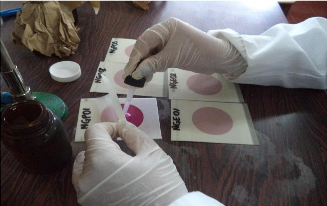
b) Inoculación de las muestras para el análisis bacteriológico de los pozos de nueva Guadalupe mediante la técnica de placas petrifil.
