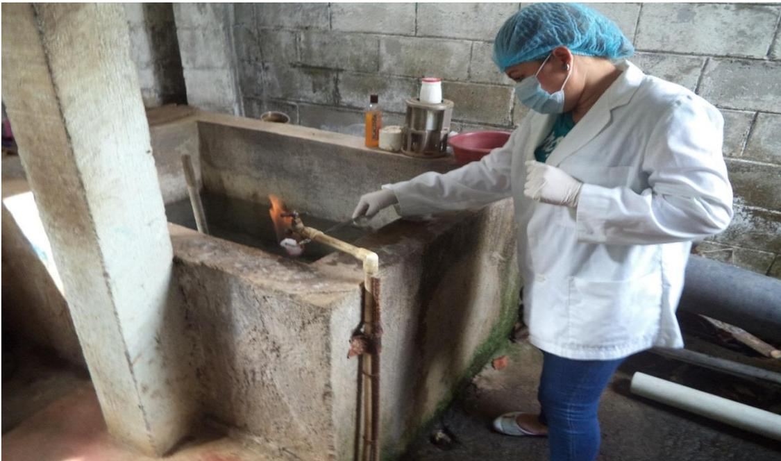
Esterilización del lugar de muestreo en el pozo de las pilas para análisis bacteriológico.
