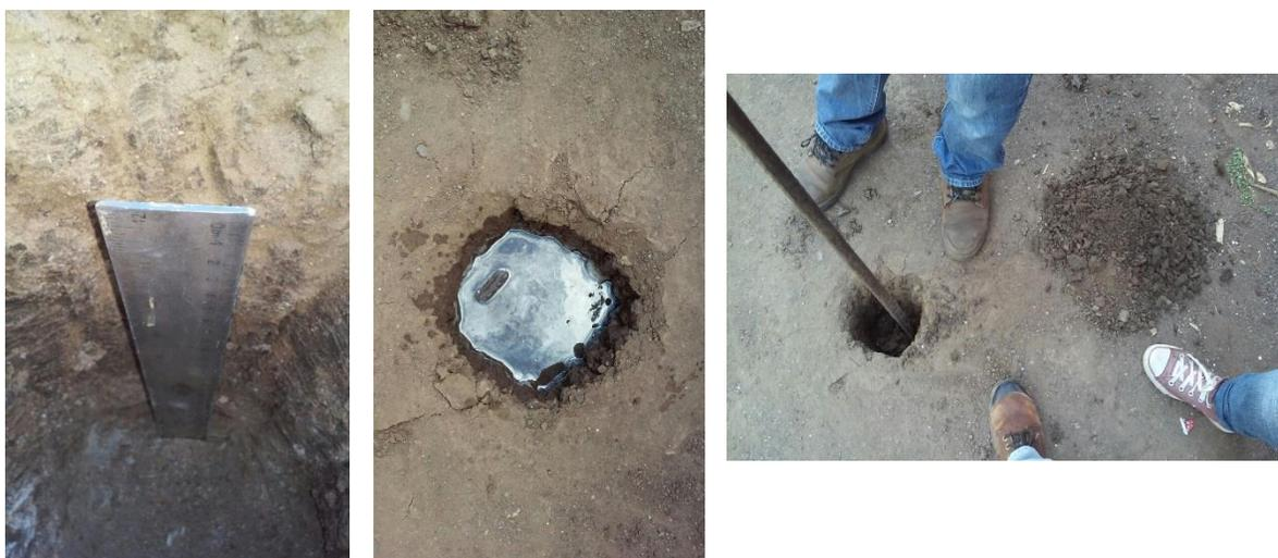
Figura 29. Perforación de agujero para implementación del método Porchet.
