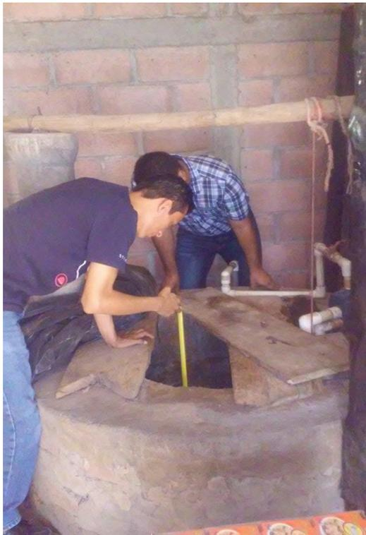
Figura 5. Toma de datos de la profundidad del nivel freático.
