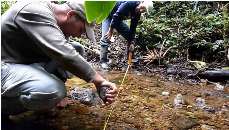
Figura 10. Forma para dividir la sección transversal de un riachuelo.
