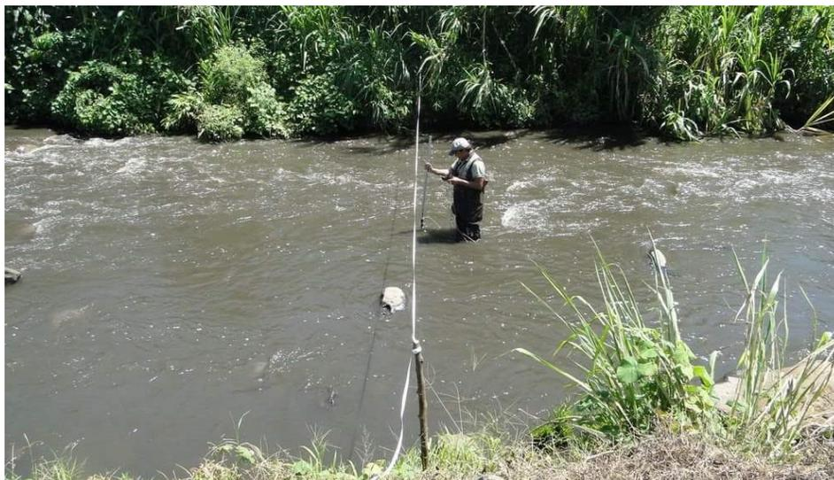
Figura 9. Medidas de la velocidad superficial de la corriente
