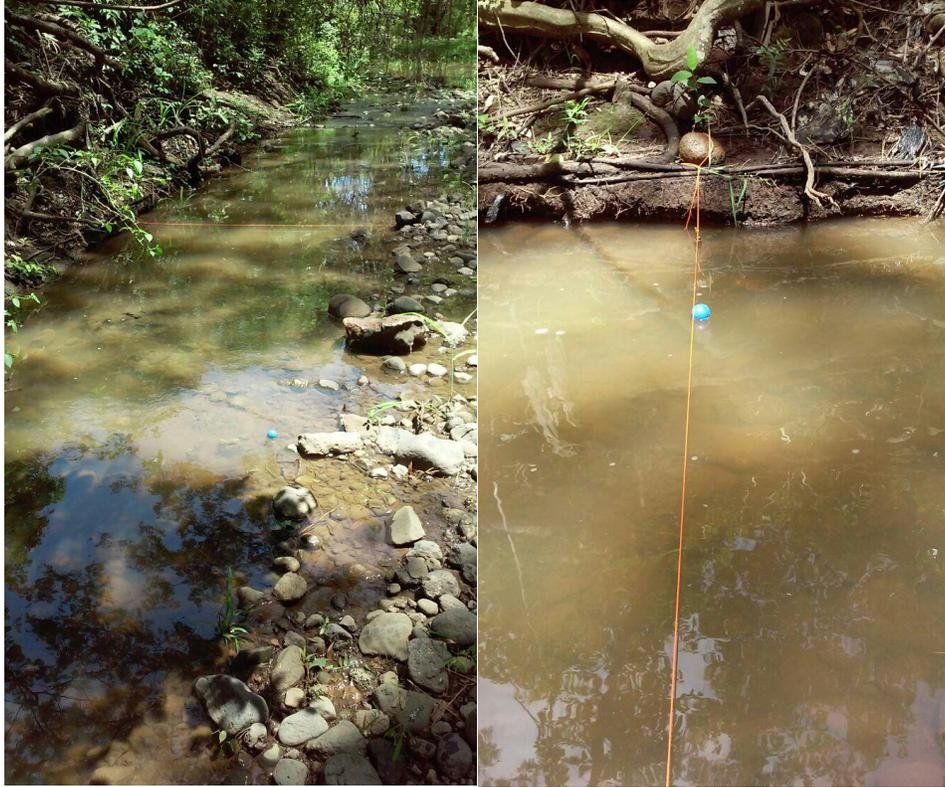
Figura 39. Aforo por medio del método de flotadores.
