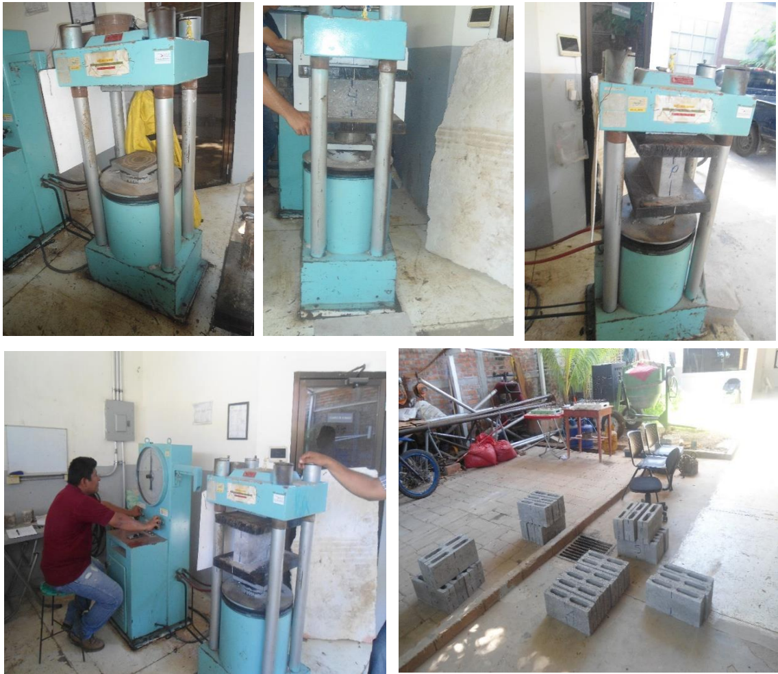
Fotografía A18: Ensayos de resistencia a la compresión de unidades de mampostería de concreto, en el laboratorio de MZ consultores
