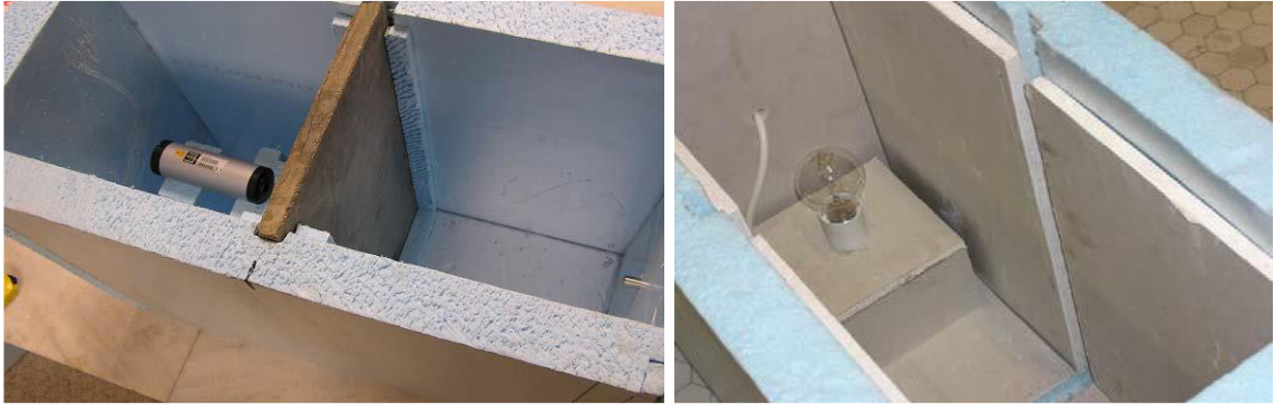
Figura A1: Equipo para el ensayo de reducción de la presión sonora, aislamiento térmico y atenuación a impacto. Para el aislamiento térmico se recubre interiormente de placas de yeso laminado.
