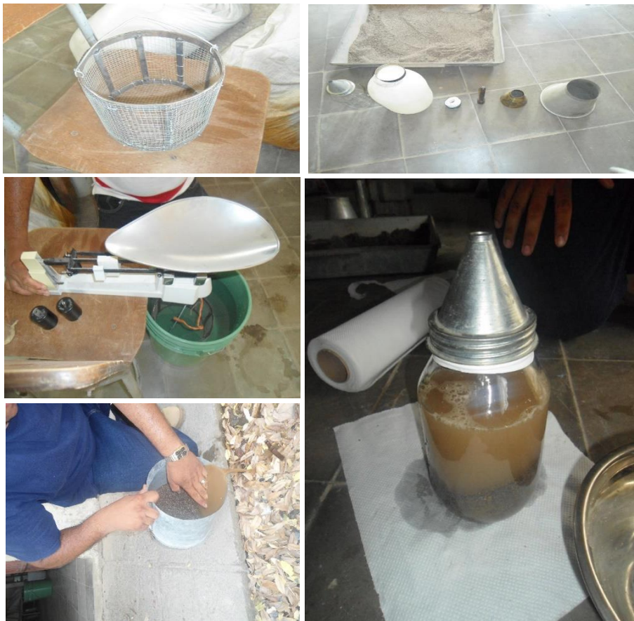
Fotografías 3.2 Procedimiento para la elaboración del ensayo de gravedad específica del agregado fino por el método del picnómetro
