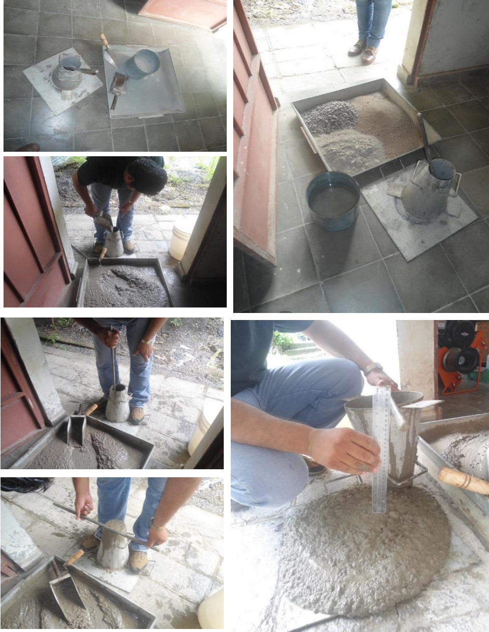
Fotografía A14: Ensayos de revenimiento a mezcla con ajuste de absorción en el laboratorio
