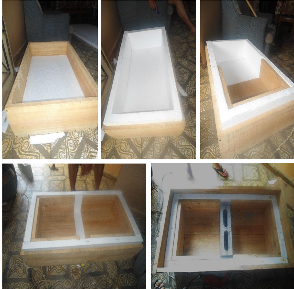
Fotografía A9: Armado de la caja con el Poliestireno
