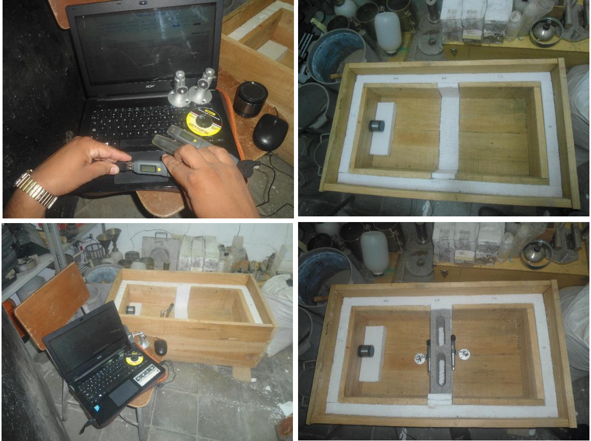
Fotografías 4.7: Procedimiento para el ensayo de absorción acústica de unidades de mampostería
