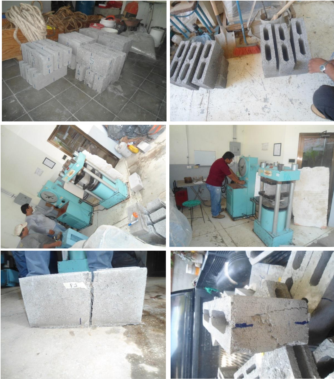
Fotografías 4.4 Procedimiento del ensayo de compresión de las unidades de mampostería de concreto y unidades de mampostería de concreto con PET
