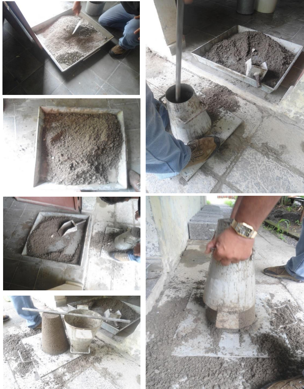
Fotografía A15: Ensayos de revenimiento a mezcla inicial sin ajuste de absorción en el laboratorio
