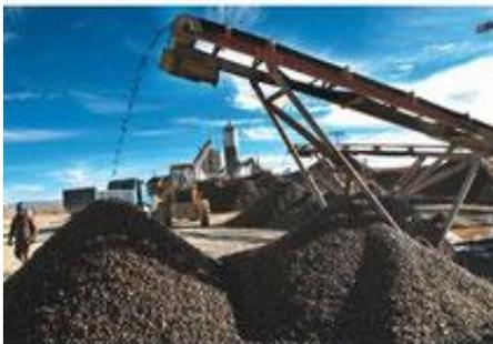
*Imagen 2.6. Acopio de agregados*
