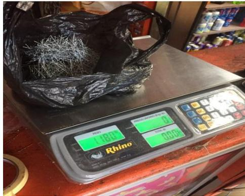
*Imagen 3.4. Peso de las diferentes cantidades de fibras metálicas.*
