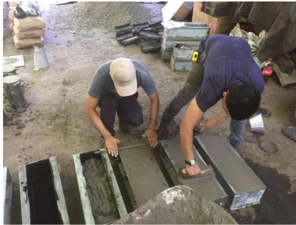
*Imagen 3.10. Fabricación de Viguetas*
