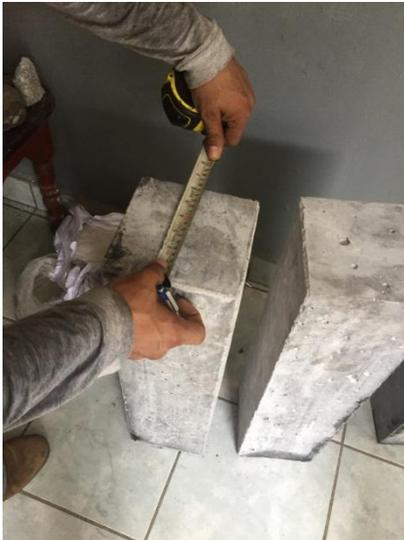
*Imagen 3.15. Medición de las viguetas para punto medios del claro*
