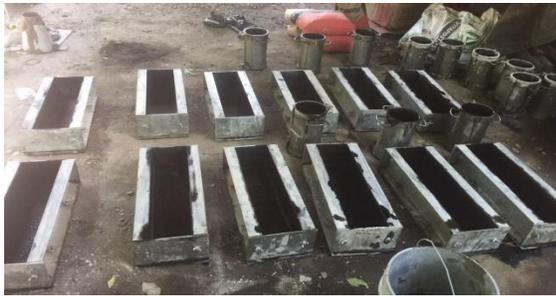
*Imagen 3.8. Moldes engrasados y colocados en una superficie plana*
