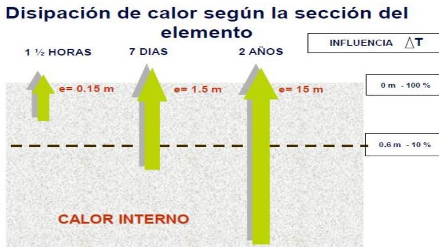
*Figura 2.6. Desarrollo de la Temperatura del Concreto durante el tiempo definido por el diseñador de la estructura*
