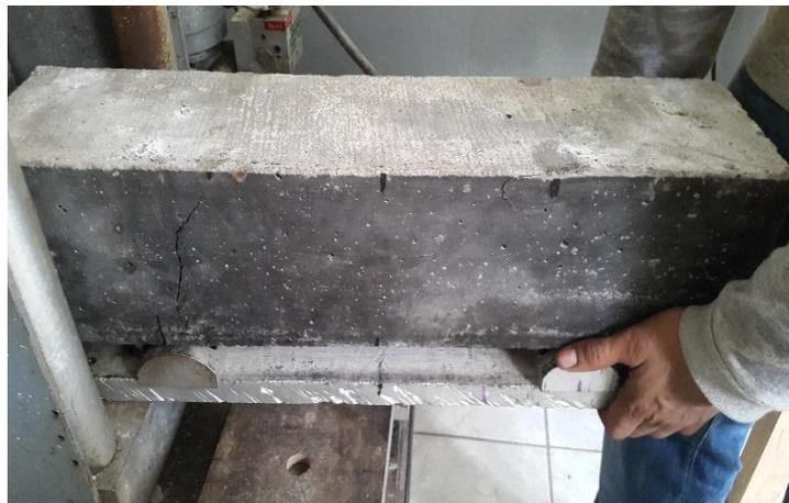
*Imagen 3.17. Vigueta después de falla con carga aplicada en tercios medios del claro.*
