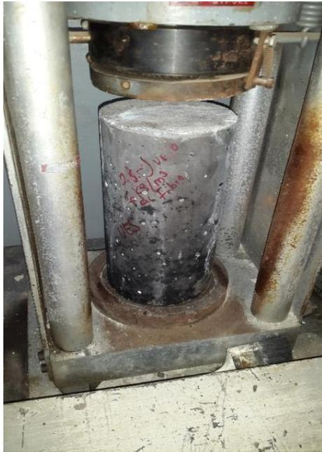
*Imagen 3.13. Cilindro listo para ensayar en la máquina.*
