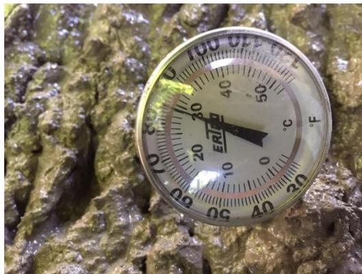
*Imagen 3.7. Toma de temperatura al concreto en estado fresco.*
