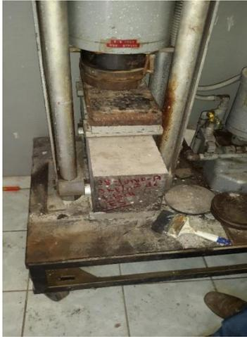
*Imagen 3.16. Ensayo de tensión puntos tercios del claro.*
