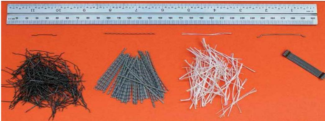
*Imagen 2.3. Tipos de Fibras. Fuente: Concreto reforzado con fibra.*
