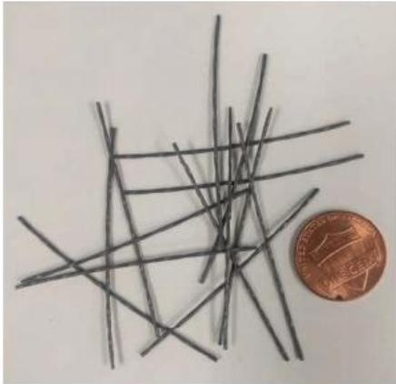
**Figura 2.4. Fibra metálica 8-52**
