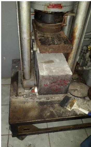
*Imagen 3.14. Ensayo de flexión punto medio del claro.*
