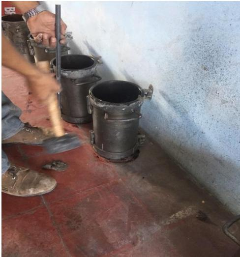
*Imagen 3.9. Golpes con martillo de goma en diferentes partes del molde*
