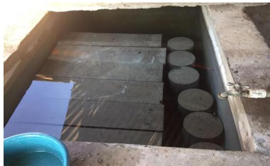
*Imagen 3.11. Curado de los especímenes de concreto*
