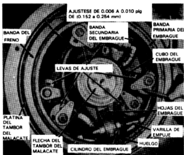
Figura 4 - Vista del embrague y el freno de un malacate (J.I. Case Company Agricultural Equipment Division)
