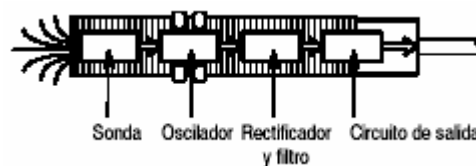
Fig. 7. Estructura del sensor capacitivo.
