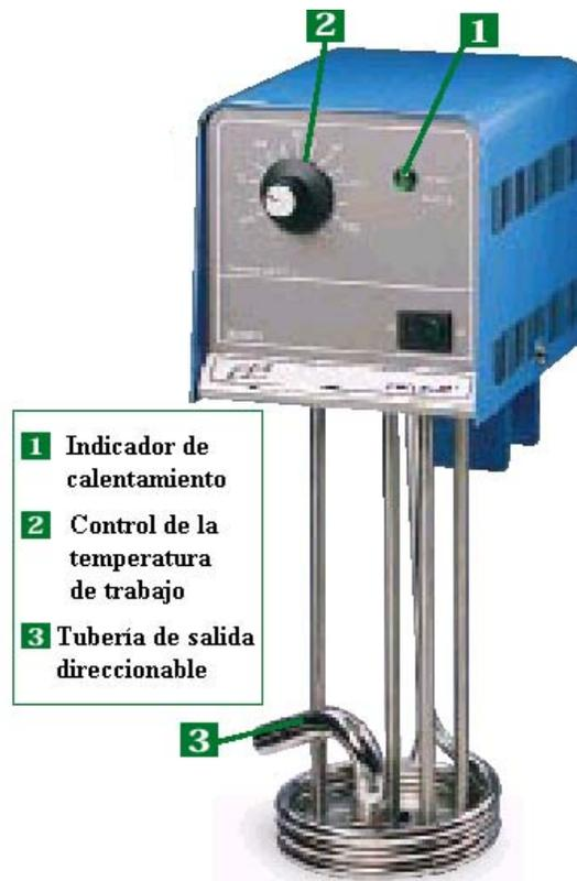
Fig.20, Unidad de calentamiento y agitación.
