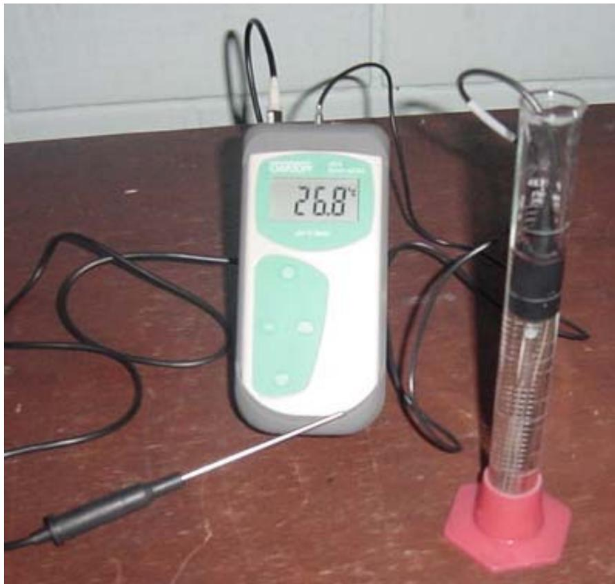
Fig.21. Medidor de pH y temperatura
