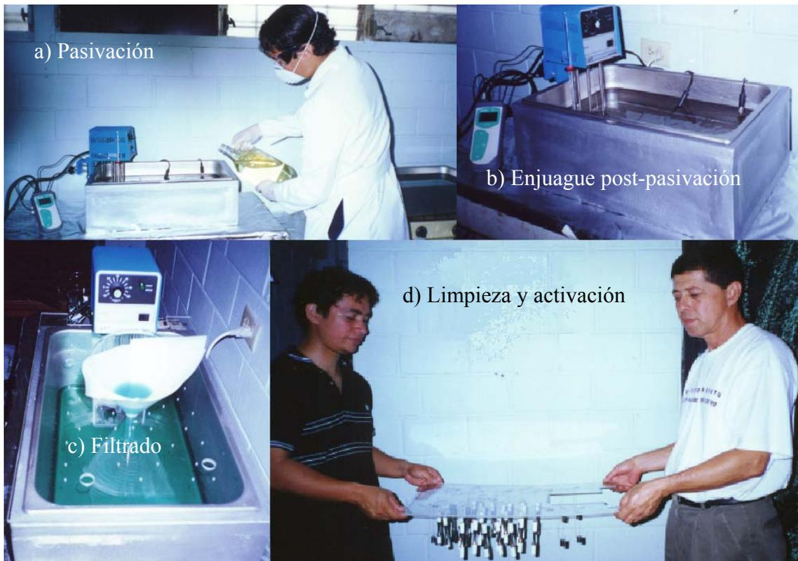
Fig. 28. Etapas principales del proceso de deposición en el sistema.
