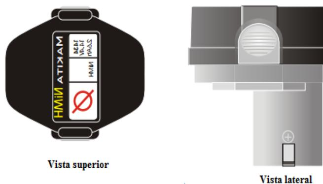
**Figura 4.7.** Esquema de la batería. Fuente: Portable diffuse flux meter LI820 Carbon dioxide, handbook 2006, manual.
