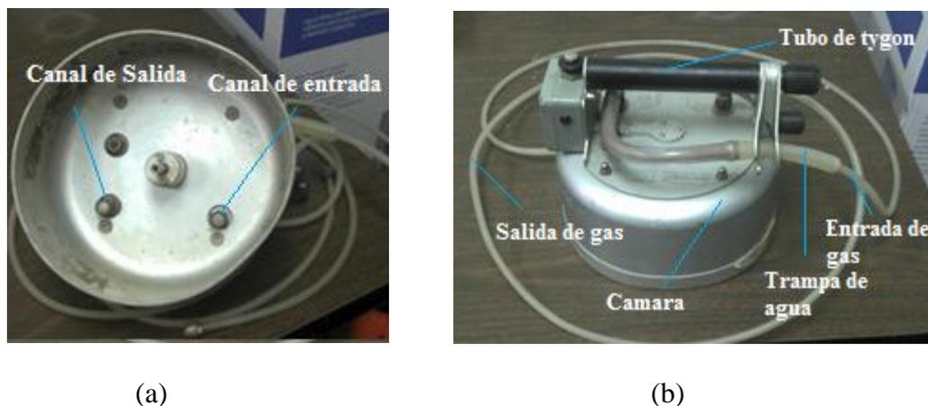
**Figura 4.6.** Cámara de acumulación. (a) Vista interna de la cámara (b) Vista de perfil
