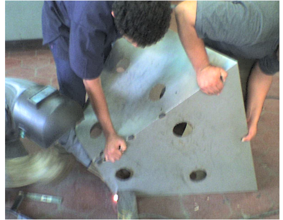
Proceso de ensamble de las caras de la carcasa 354 .
