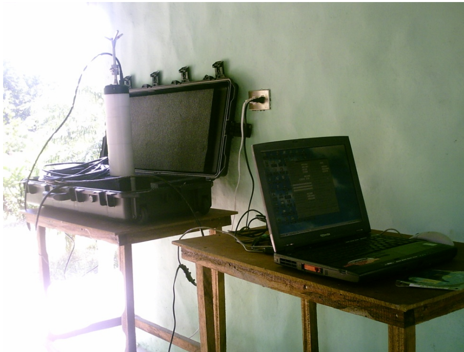
Conexión del cable de comunicación y alimentación de la sonda ADV Triton a la PC 344 .
