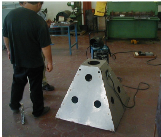
Ensamble de la base superior y elementos de sujeción en la carcasa 357 .
