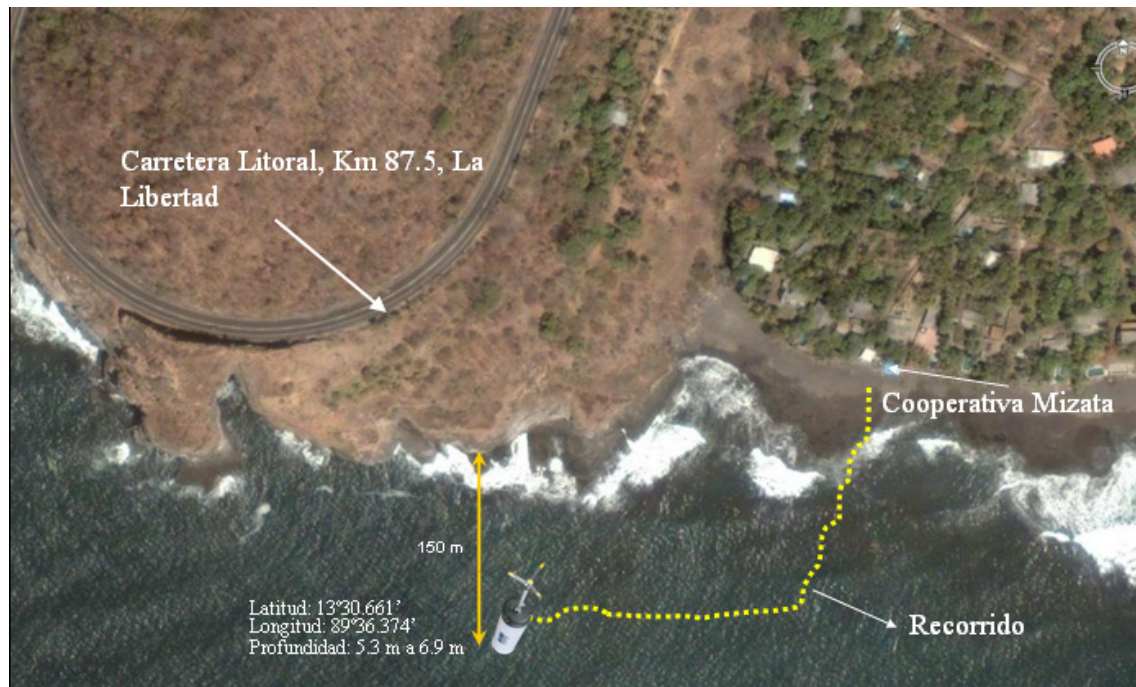
Figura 4-4: Trayectoria para la instalación y extracción de la sonda oceanográfica ADV Triton 258 .
