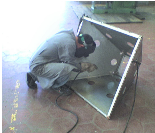
Refuerzo interno de la carcasa y ensamble de la base inferior 356 .
