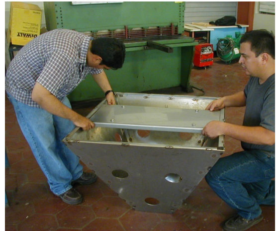
Refuerzo interno de la carcasa y ensamble de la base inferior 356 .
