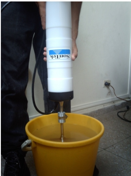
Montaje de la punta de prueba, de la sonda oceanográfica ADV Tritón, en el recipiente con agua 333 .
