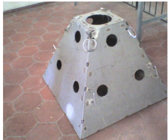
Ensamble de la base superior y elementos de sujeción en la carcasa 357 .
