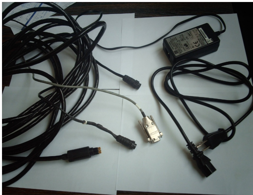
Cables de energía y comunicación con la PC 331 .
