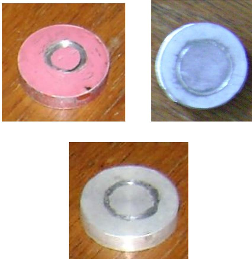
Fig. 5.13. Huellas producidas por el desgaste de la espiga sobre la probeta.
