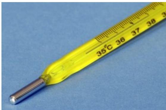
Fig. 2.6. Medidor de temperatura análogo de contacto.
