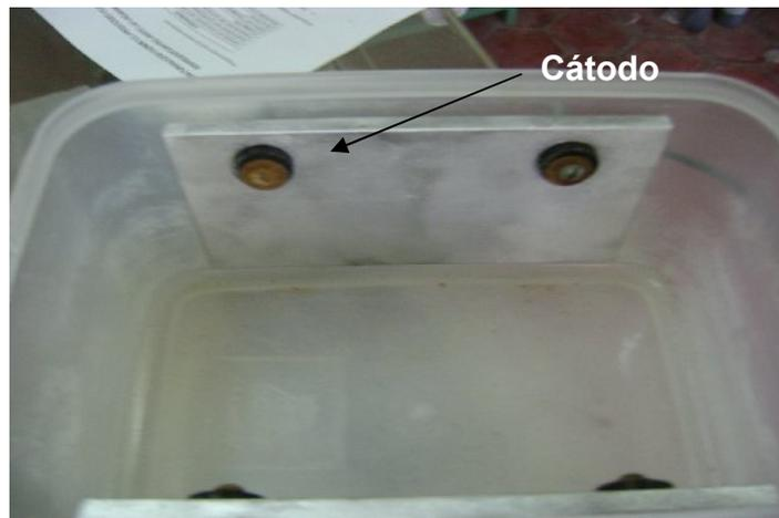
Fig. 5.4. Depósito para la realización de la electrólisis donde se observa el cátodo, antes del inicio del proceso de anodizado.
