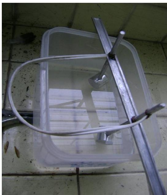
Fig. 5.1. Desengrasado de los especímenes, en una solución de 5% de ácido sulfúrico y 95% de agua destilada.
