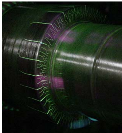
Fig. 4-34: Eje con cambios de sección ensayado con partículas magnéticas, en el cual se ve claramente grietas.
