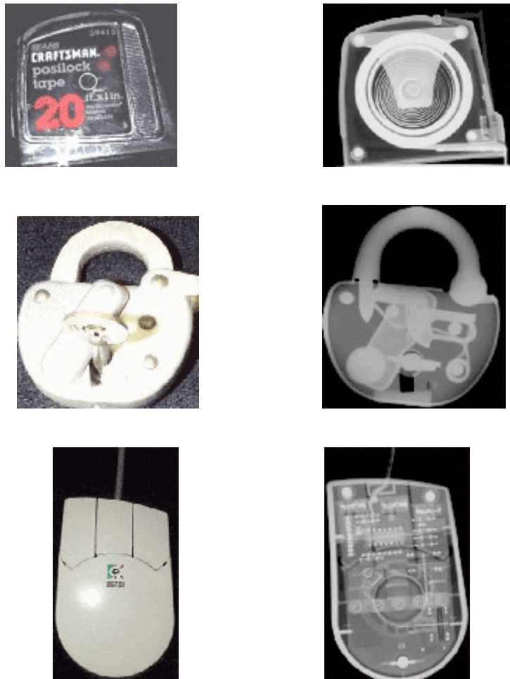
Fig. 6-1: Ilustración de la comparación entre una fotografía a la izquierda versus la radiografía del mismo objeto a la derecha.
