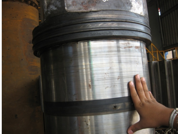
Fig. 10-12: identificación de grietas.
