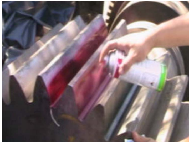
Fig. 10-8: Aplicación del líquido penetrante.
