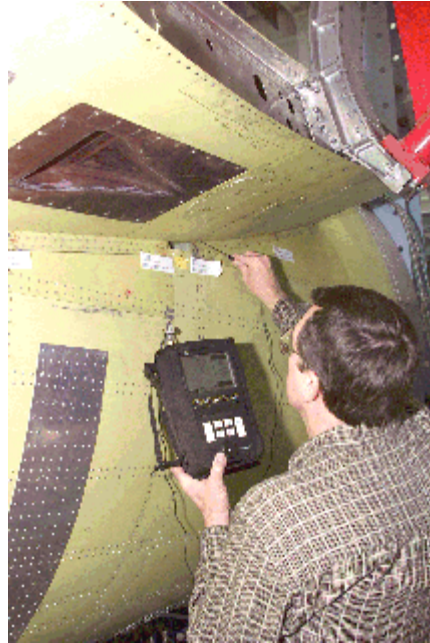
Fig. 5-39: Inspección en los empalmes del fuselaje de un avión.
