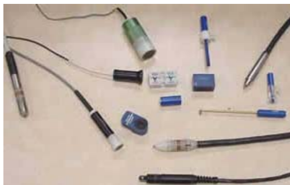
Fig. 5-10: Puntas de prueba de corrientes de Eddy.
