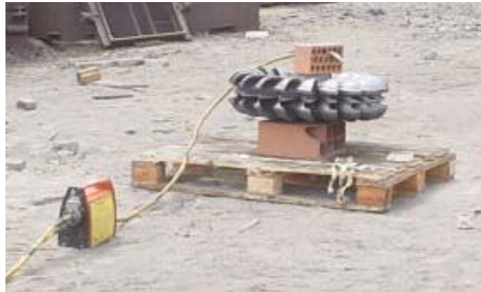
Fig. 6-3: Fotografía que muestra como se lleva a cabo una radiografía In Situ con un equipo de radiación gamma.
