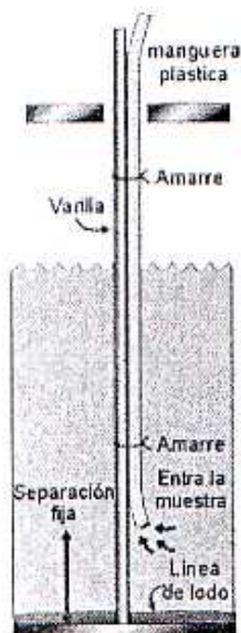
Fig. 8-16: Otra manera de obtener una muestra de fluido en un sistema circundante.
