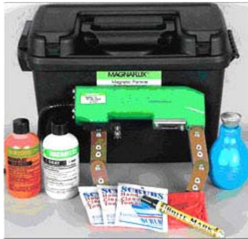
Fig. 4-22: Equipo para ensayos con partículas magnéticas.
