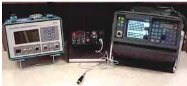
Fig.5-6: Instrumentos de la Corriente de Eddy.
