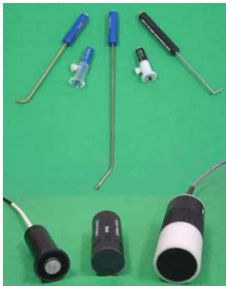
Fig. 5-13: Puntas de prueba de la superficie.
