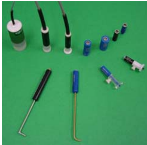
Fig. 5-11: Puntas de prueba absolutas.
