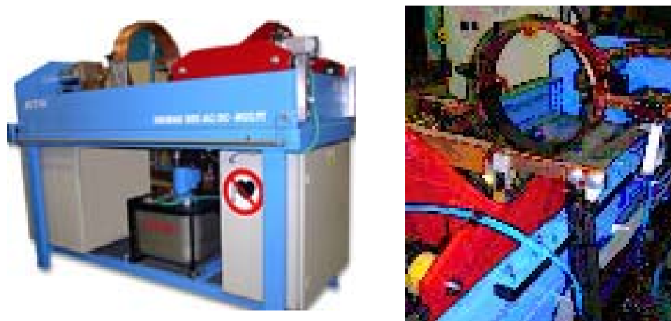
Fig 4-29: Banco para ensayos con cabezales con ajuste neumático para piezas de hasta 400 mm de longitud. Incluye bobina desplazable de 305 mm (disponibles también de 406 y 508 mm) y permite la operación con AC y FWDC (conforme a ASTM E-1444). Armario de control con interruptores para selección y depósito de 15 litros con agitador y bomba de circulación. con función de desmagnetización automática.
