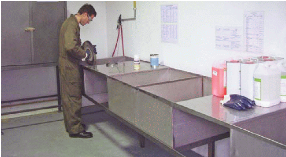
Fig. 15-3: Banco de para realizar ensayos de líquidos Penetrantes (Cuba) en un laboratorio.
