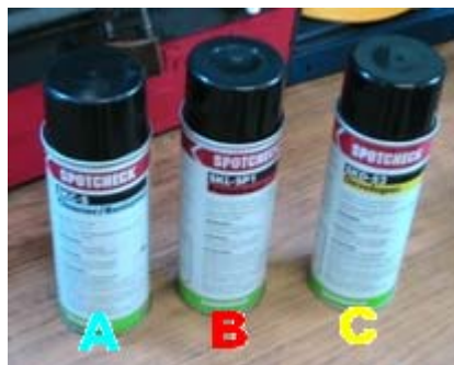
Fig. 3-8: limpiador (A), penetrante (B) y revelador (C).
