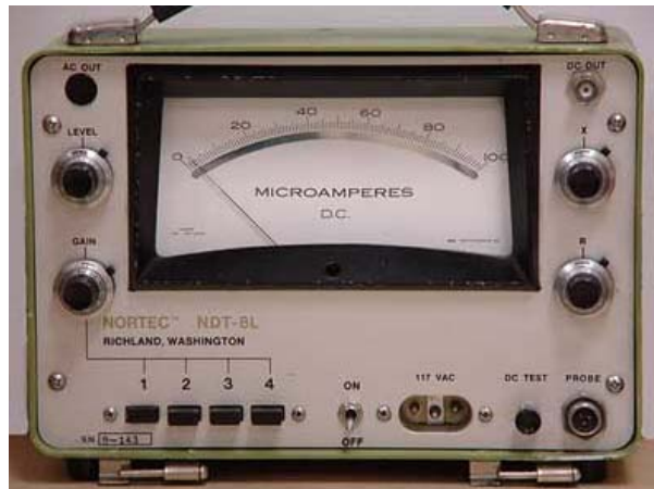
Fig. 5-9: Instrumento Análogo de las corrientes de Eddy.
