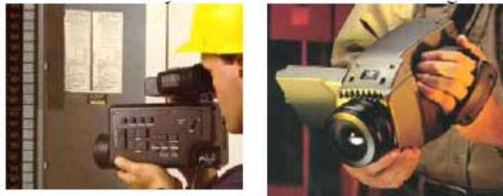
Fig. 1-18: Cámara infrarrojas con visor mono -ocular y con monitor externo.
