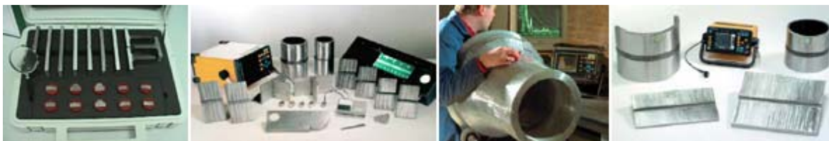
Fig. -4-27: Conjunto de probetas con defectos tipo o especiales Colección de probetas con defectos típicos o específicos requeridos. Disponibles probetas en distintos materiales (acero, aluminio, etc.), con geometrías diferentes y con defectos característicos de procesos de moldeo, forja, soldadura, etc.
