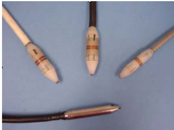
Fig. 5-14: Puntas de prueba de Diámetro Interior.
