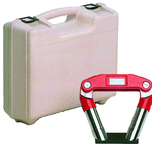
Fig. 4-24: Yugo Imán permanente con su caja de transporte.
