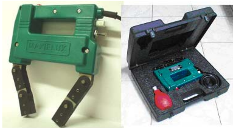
Fig. 4-23. Yugo electromagnético, Flujo que magnetiza: CA/CC. Energía de entrada: 110 /230 V.
