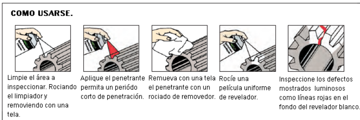
Fig 3-7: Esquema que muestra como se aplican los líquidos limpiadores, penetrantes y reveladores en un ensayo de líquidos penetrantes.
