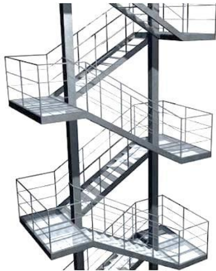
Imagen 73. Sistema de Escaleras de Emergencias
