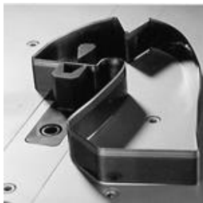
Suaje para llevar a cabo el troquelado de cuero, forros y plantillas
