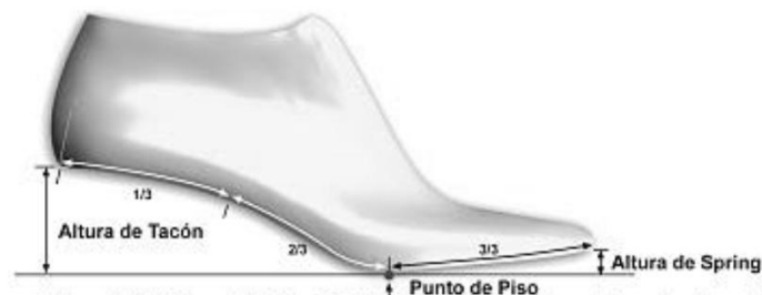
(Balance ideal de la horma) Ubicado a 2/3 de la longitud de talla de la horma (sin considerar la punta falsa)
