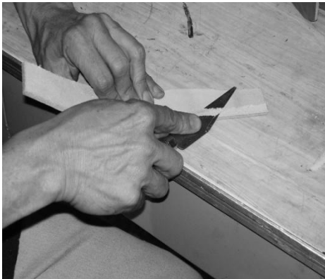
Rebajado/Desbastado manual con cuchilla
