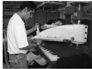
Operario llevando a cabo la operación de troquelado en cuero.
