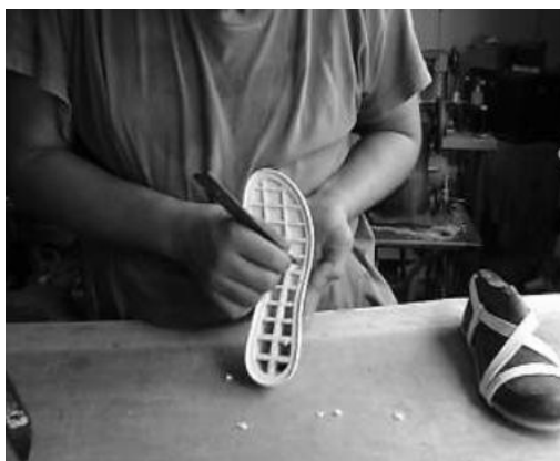
Cardado/Raspado manual con cuchilla
