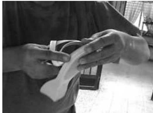
Colocación de suela
