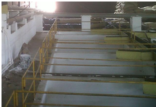
Figura . Pilas de fermento con protección contra caídas
