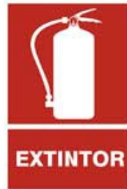
Figura . Señalización de Equipos Extintores
