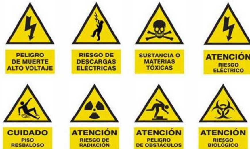
Figura . Señales de advertencia
