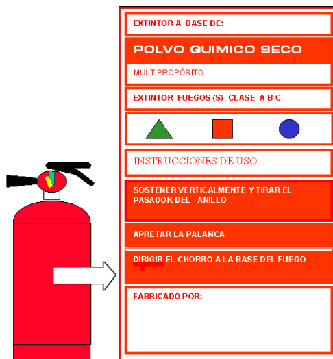
Ilustración 15. Etiqueta de identificación del extintor
