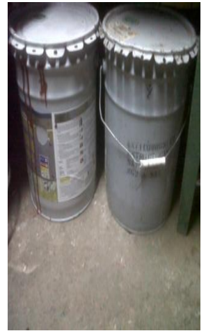
Foto 138. En el area de taller se puede observar la pintura la cual no está cerrada completamente por lo que el olor esta en toda el almacen, se puede ver que no tienen cartillas ni instrucciones de uso, ni están en lugares adecuados.
