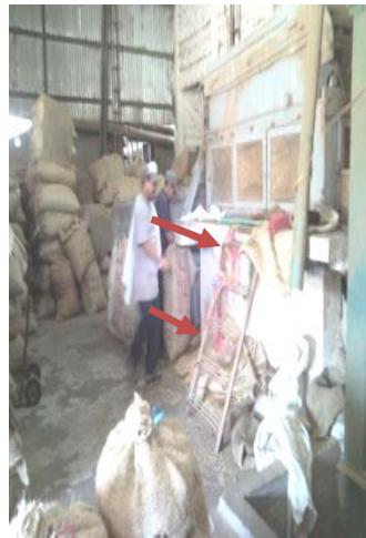
Foto 33. El personal de trilla 2 puede sufrir caidas por la escalera, debido a que el escalon es angosto y no posee barreras de proteccion. Ademas el espacio para inspeccionar el proceso de clasificacion es muy estrecho y sin barrera.
