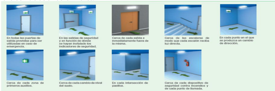
Figura . Zonas de instalación de luminarias de emergencia
