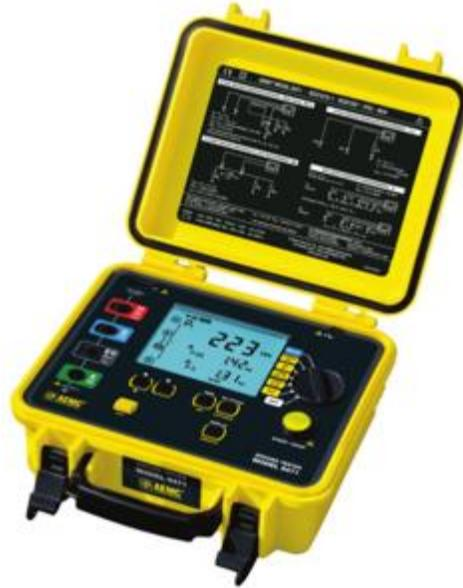
Fig. 31: Telurómetro modelo 6471
