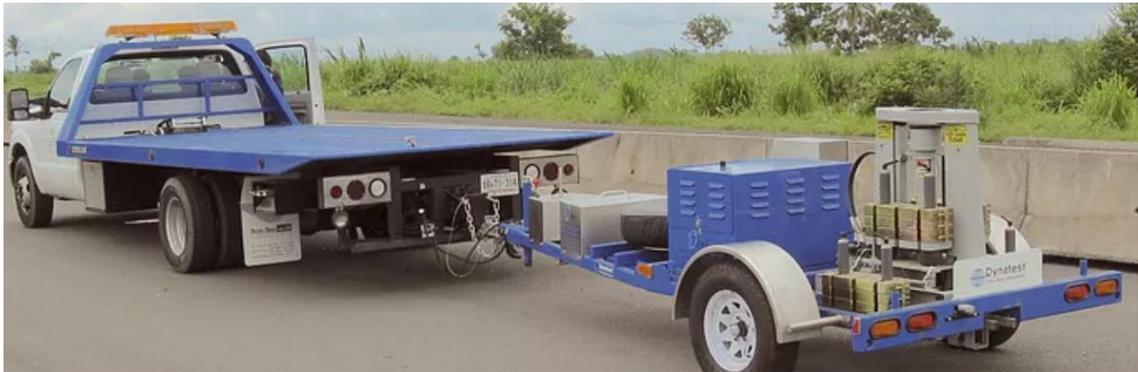
*Figura 2.19 Deflectómetro en Remolque*
