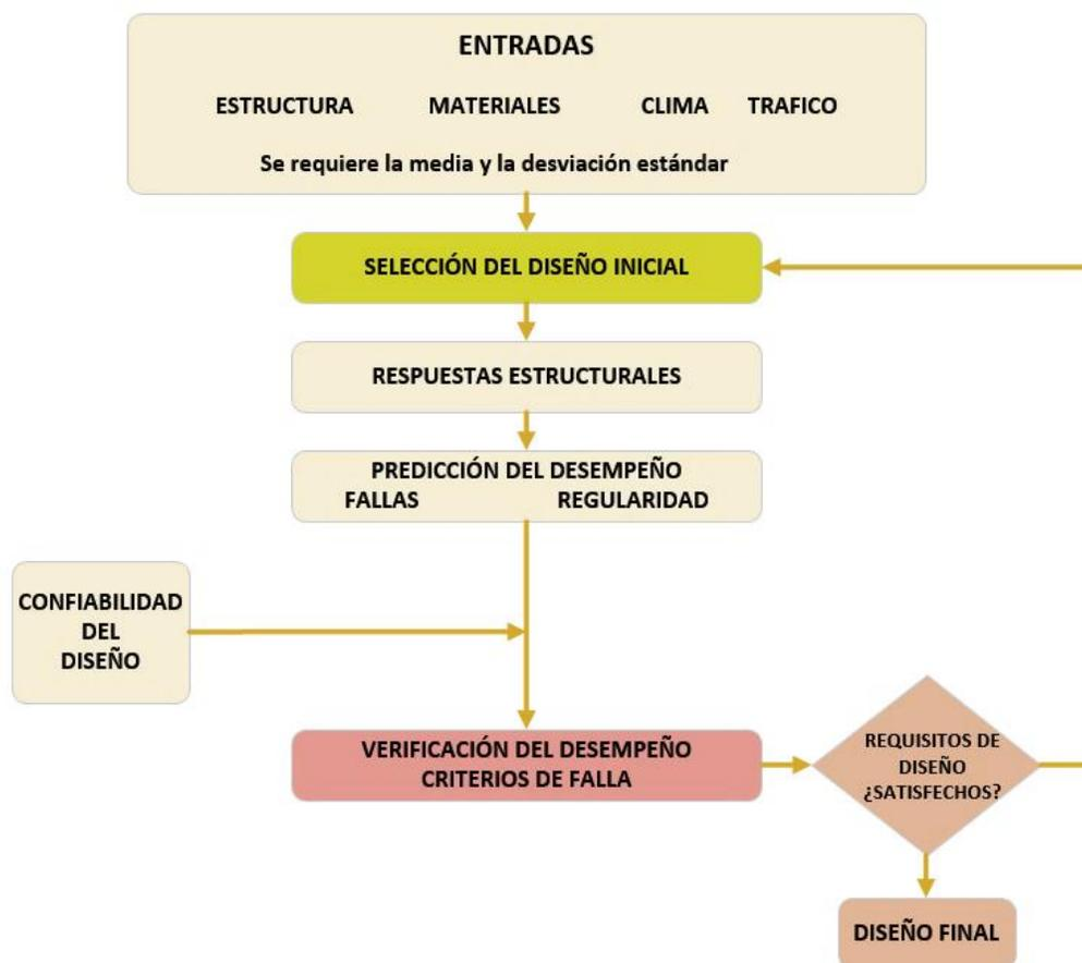
Figura 2.11 Proceso de Diseño Mecanicista-Empírico
