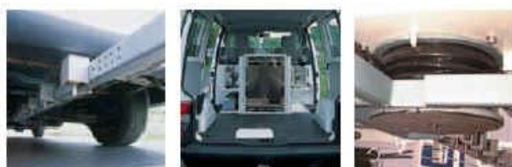
*Figura 2.18 Deflectómetro en Furgoneta (Geófonos – Computadora – Placa de Carga)*
