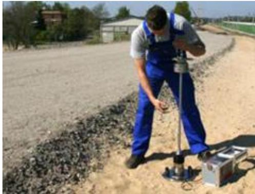
*Figura 2.16 Deflectómetro Portátil*
