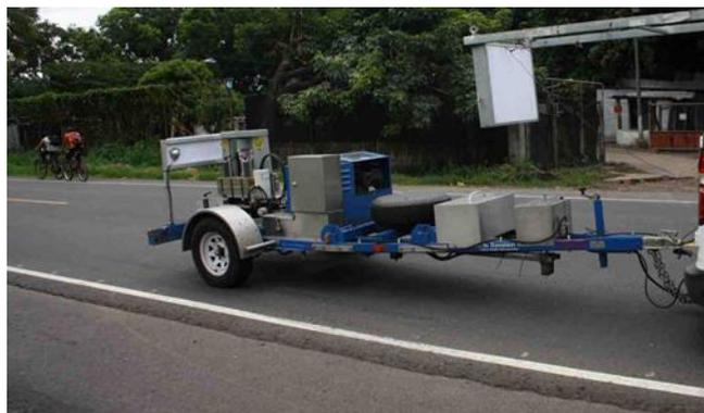
Figura 3.16 Ubicación al eje del carril, ensayo FWD.
