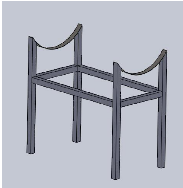
Figura 45. Estructura de soporte del tanque acumulador.
