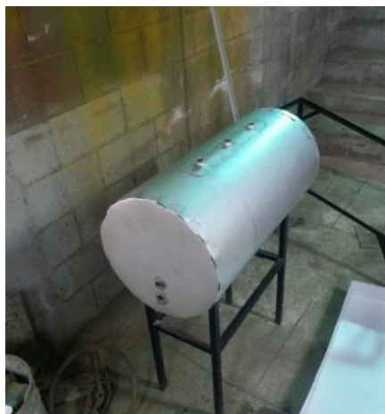
Figura 55. Tanque acumulador finalizado.
