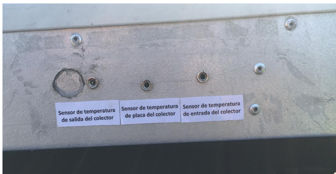
Conectores de sensores de temperatura en la caja colectora.
