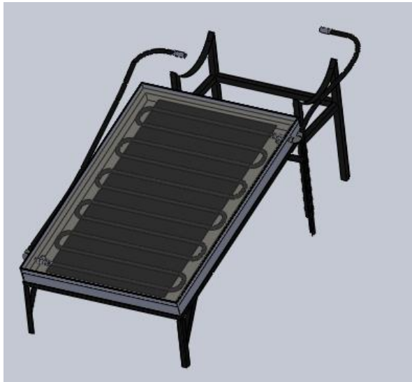
Posición correcta de las instalaciones de las mangueras en el colector solar
