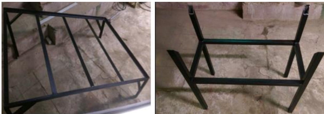
Figura 49. Soporte del colector y de tanque acumulador.
