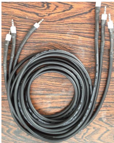
Cables conectores para los tres sensores de temperatura ubicados en la caja colectora.
