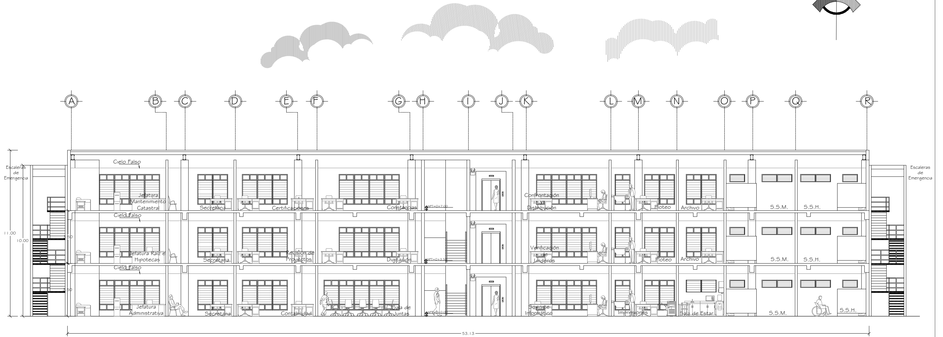
CORTE A-A EDIFICIO ADMINISTRATIVO ESC. 1:175
