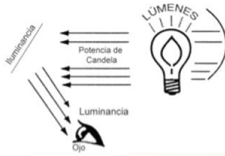
Ilustración 16 Sistema de Iluminación
