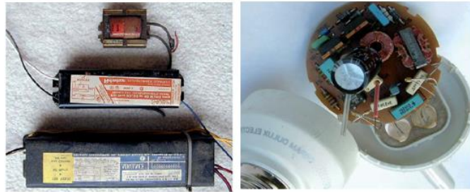
Ilustración 22 Balastro magnético y balastro electrónico
