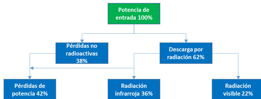
Ilustración 23: Balance de energía de una lámpara fluorescente
