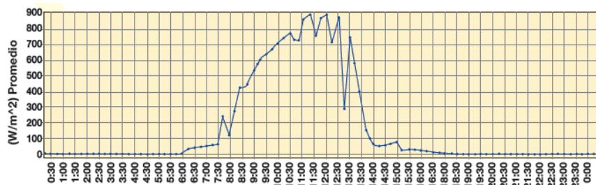
Gráfica 2: Irradiación (W/m 2 ) Sensor Box del 26 de agosto de 2012, día con muchas nubes
