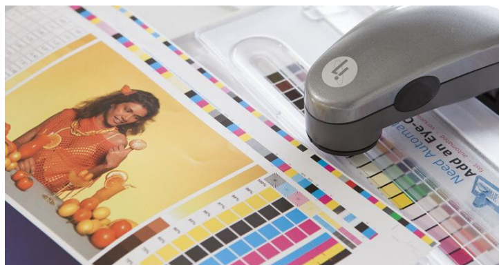
Representación del uso del colorímetro en la barra de calibración.
