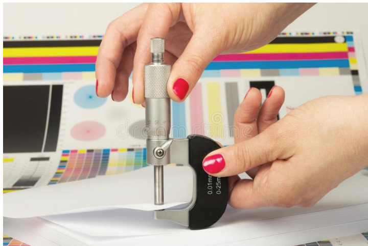
Ilustración de la forma de usar un micrómetro para medición de papel.
