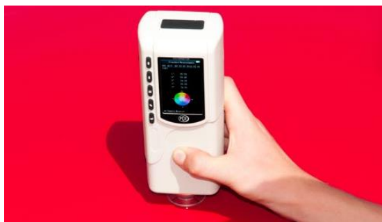
Uso de colorímetro en una muestra de papel.
