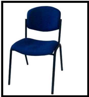
Silla Novara Paño. Estructura metálica en tubería redonda 7/8", Parte trasera del espaldar en concha plástica, Espuma de 3 cms Densidad 26, Altura total 79 cms, Altura asiento 44 cms, Ancho 49 cms. $
