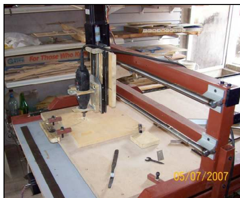
Figura 14 y 15: Equipos CNC de fabricación casera.
