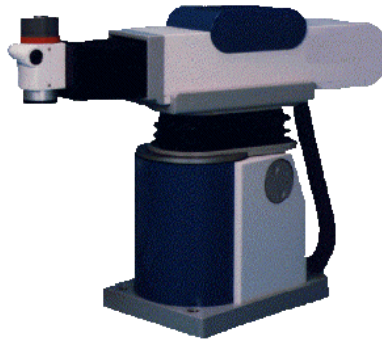
Figura 3 y 4: Brazo Manipulador. Configuración Cilíndrica.
