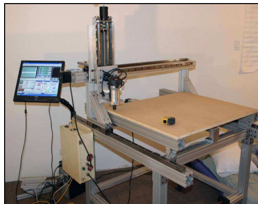
Figura 14 y 15: Equipos CNC de fabricación casera.
