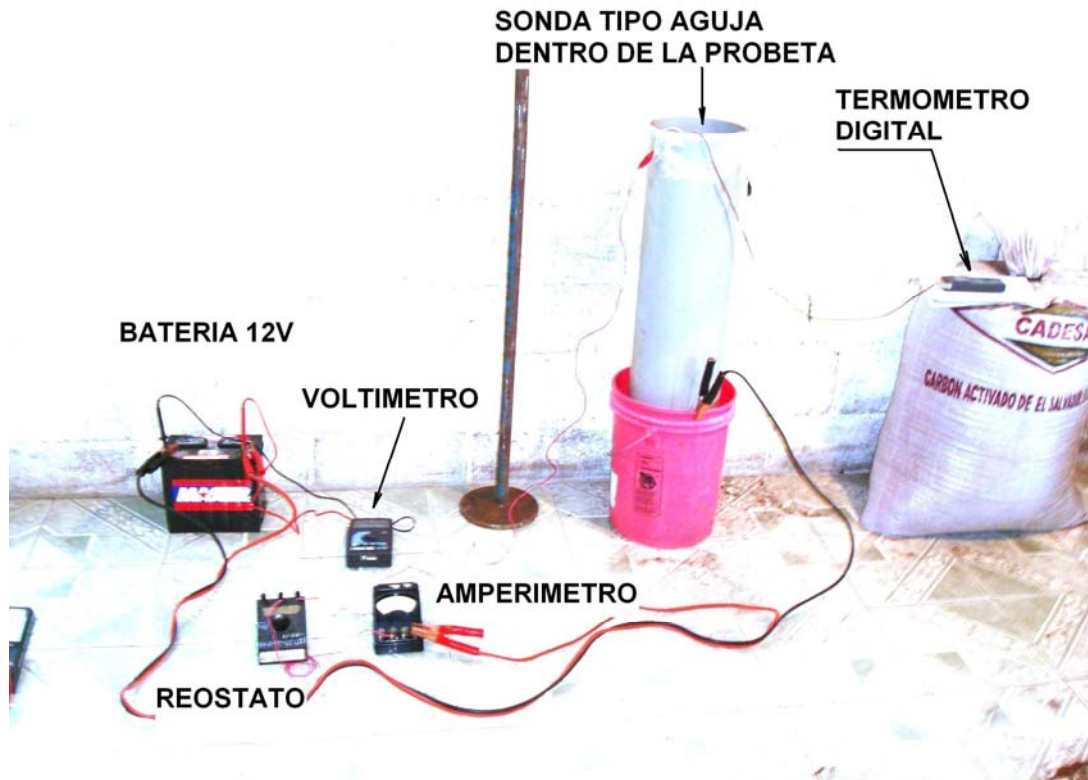
Figura 14: Montaje del equipo para medición de la conductividad térmica.
