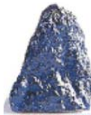
Fig. 1.11. Grano de óxido de aluminio.
