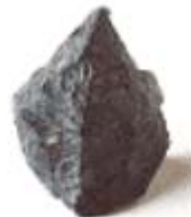
Fig. 1.10. Grano de alúmina zirconia.
