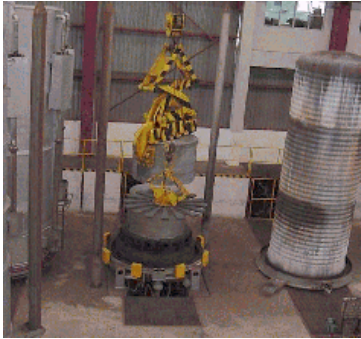
Cargado de la base con 5 bobinas con convector intermedio
