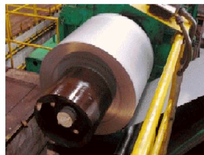
Material LAC decapado en sección de salida de la línea
