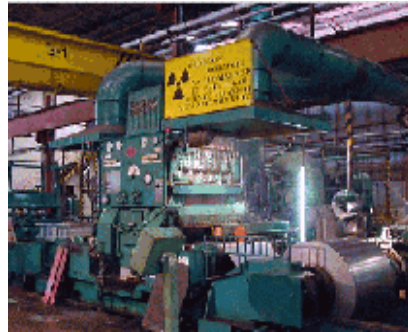
Material LAC en laminador reversible con molino múltiple
