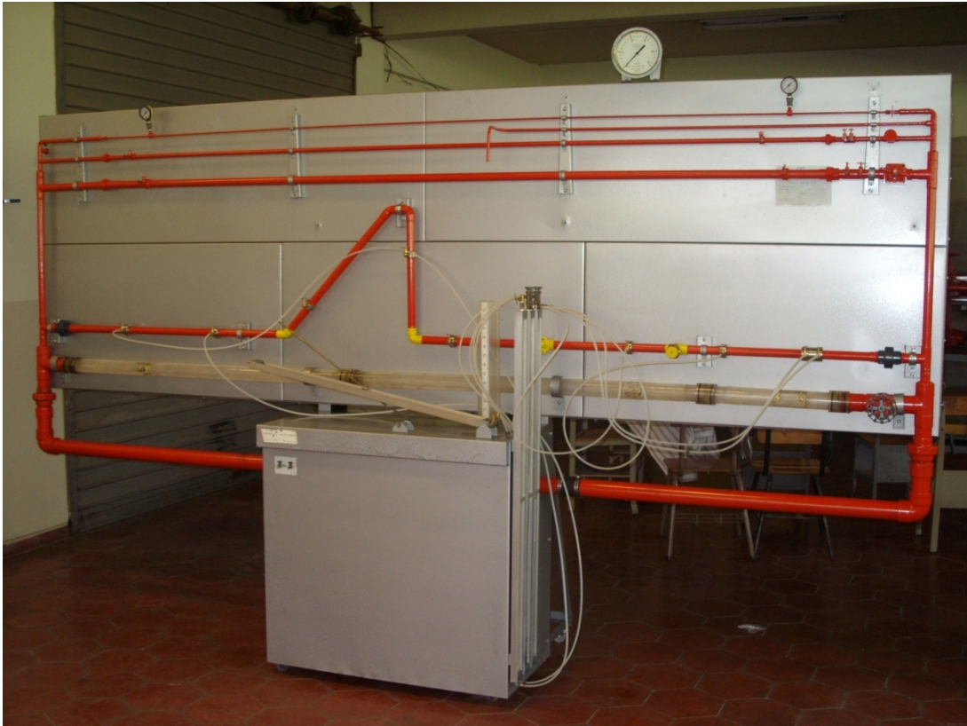
Figura 2.8 Fotografía del banco para determinar pérdidas de energía habilitado.
