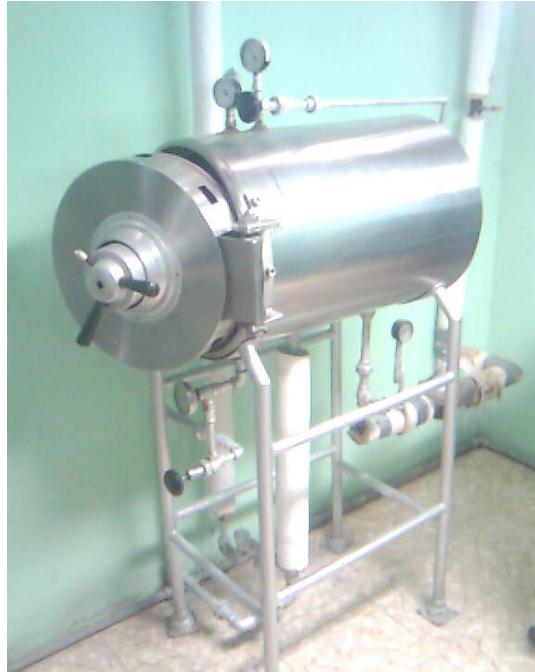
Fotografía 2. Autoclave marca Consolidate en funcionamiento Presenta deformación en la puerta y un manómetro en mal estado
