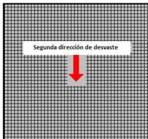
Figura 3. 7 Patrón de marcado que se debe procurar en las platinas
