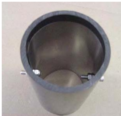
Figura 3. 12 Ensamble del electrodo a la tubería
