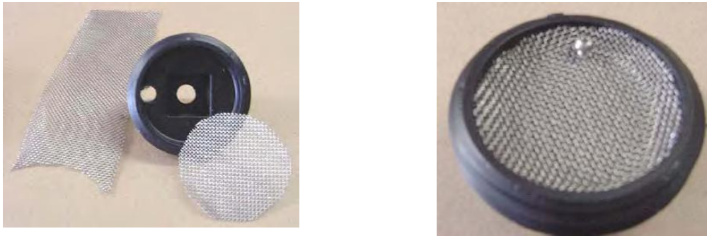
Figura 3. 15 Ensamble de la malla en la tapadera superior
