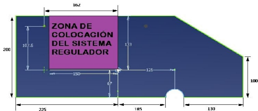
Figura 82 Zona de colocación del sistema regulador
