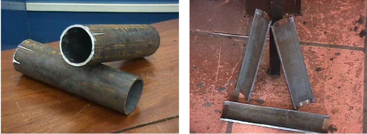
Figura 22 Tubos enteros y cortados para la confección de los álabes [33]
