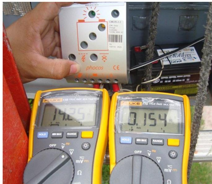
Figura 3.16: Medición de voltaje y corriente con una batería de 9AH
