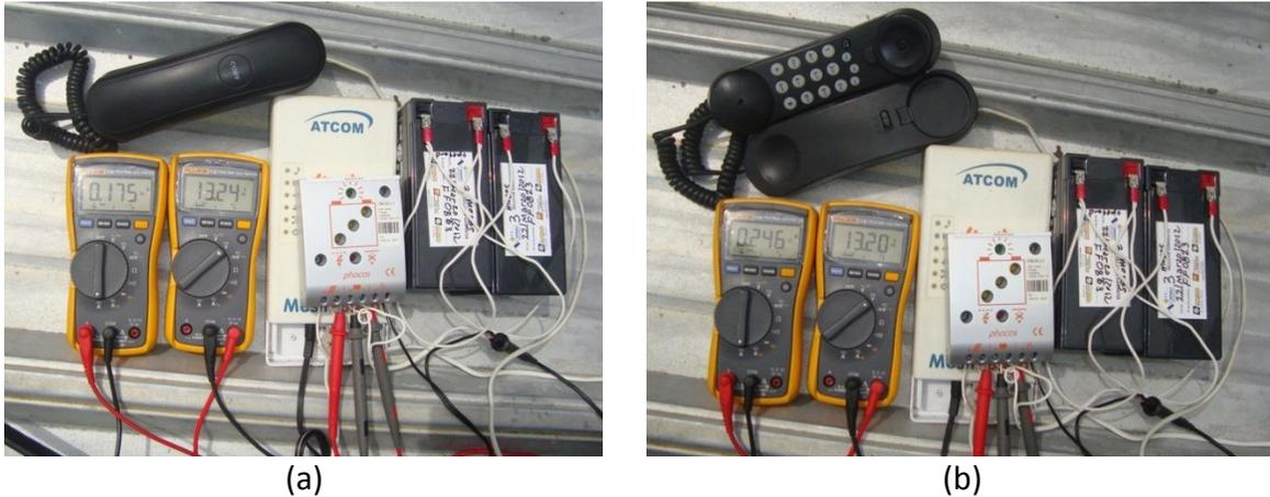
Figura 3.17: Medición de corriente y voltaje en la carga con teléfono colgado.
