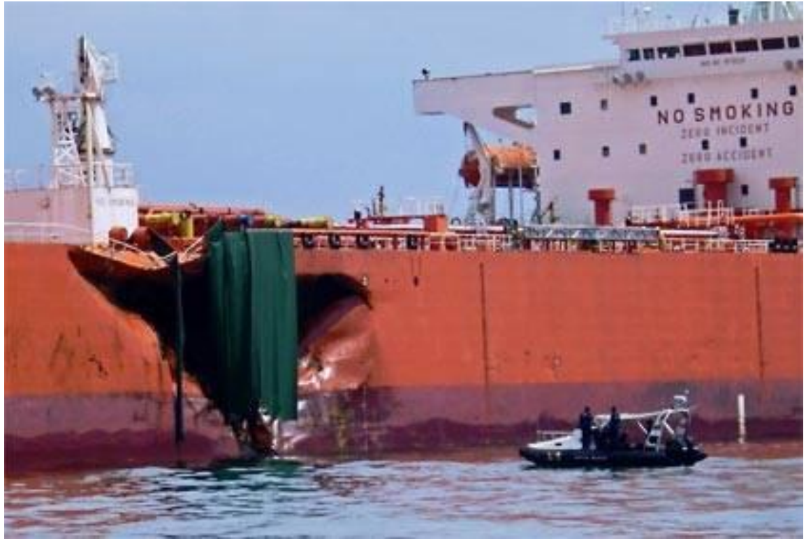
Fig. 1.6. Foto del MV KIRKI, se aprecia la pérdida de un panel frontal de proa.
