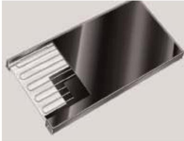
**Figura 6.1** Disposición de tubos en forma de serpentín.
