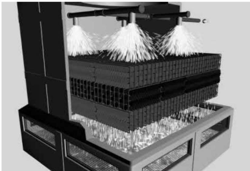
**Figura 4.15** Relleno de una torre de enfriamiento.
