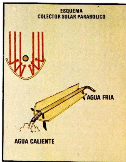
Figura 6.4 Tipos de colectores solares de concentración.
