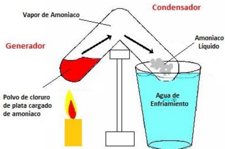
**Figura 2.11** Desorción y condensación de amoníaco a alta temperatura.
