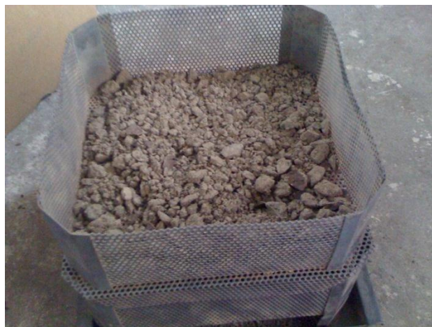
FIGURA 5.31 – Agregado extraído al final del ensayo de extracción de ligante asfáltico por ignición, y a realizarse la granulometría.
