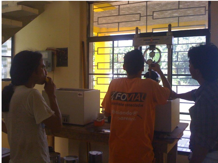
FIGURA 5.18 – Aplicación de carga durante el ensayo de estabilidad y flujo. Fuente: Laboratorio Planta Asfáltica, Plantel Los Zacatillos Constructora DISA, Zacatecoluca, La Paz
