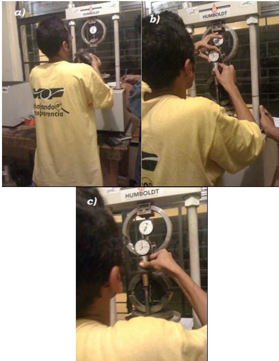
FIGURA 5.17 – Colocación de briqueta antes de ensayo: a) Colocación en maquina de ensayo de ensamble briqueta + quijada. b) Ajuste medidor de flujo a cero. c) Manga de medidor flujo sostenida firmemente.
