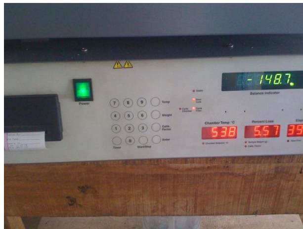
FIGURA 5.28 –Ensayo de extracción de asfalto por el método de ignición ASTM D6307-05: Fuente: Laboratorio Planta Asfáltica, Plantel Los Zacatillos Constructora DISA, Zacatecoluca, La Paz
