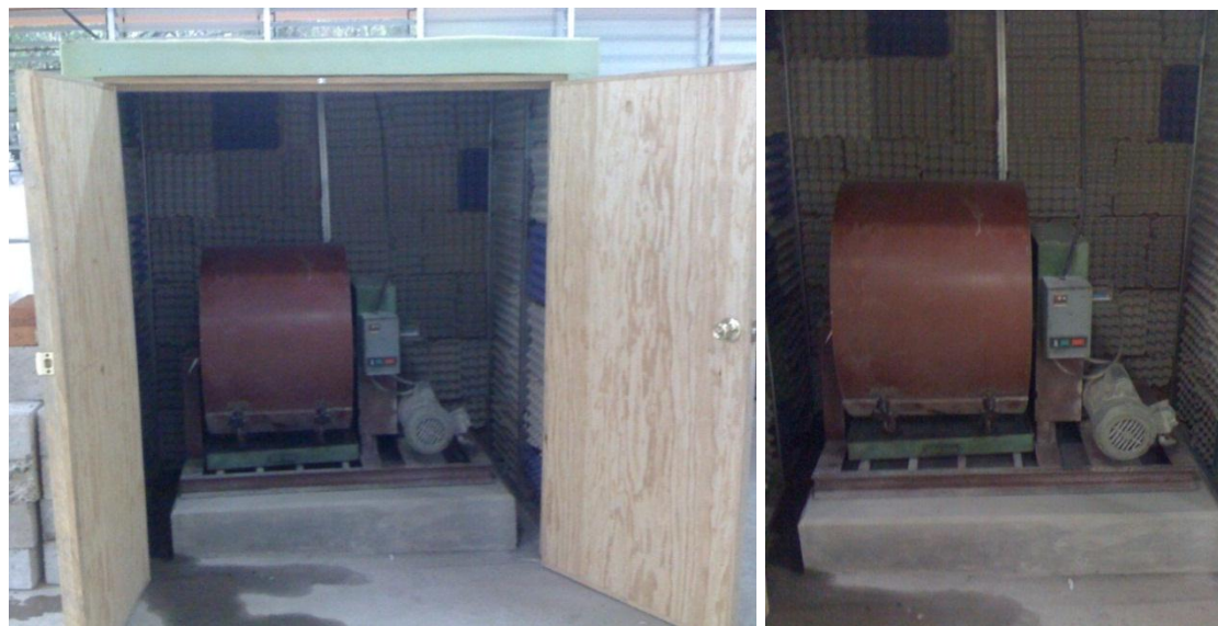
FIGURA 2.5 – Maquina de Desgaste de Los Angeles. Fuente: Laboratorio de Escuela de Ingeniería Civil, UES.
