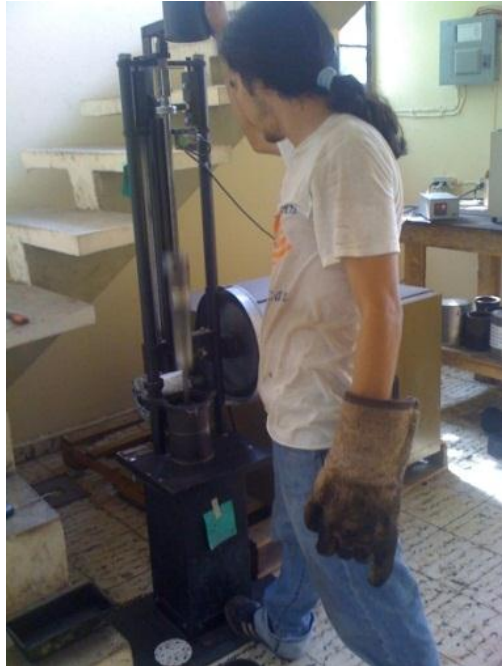
FIGURA 5.8 – Compactación de la mezcla Asfáltica.
