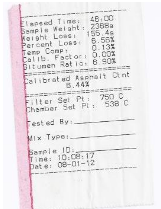
FIGURA 5.29 – Copia impresa proporcionada por el horno de los resultados: Fuente: Laboratorio Planta Asfáltica, Plantel Los Zacatillos Constructora DISA, Zacatecoluca, La Paz
