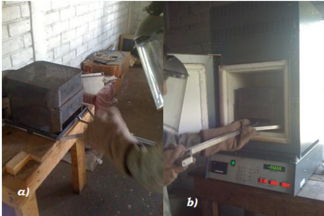
FIGURA 5.27 –Ensayo de extracción de asfalto por el método de ignición ASTM D6307-05: a) Contenedores con la muestra antes de ser colocada en el horno. b) Colocación en el horno del contenedor con la muestra.
