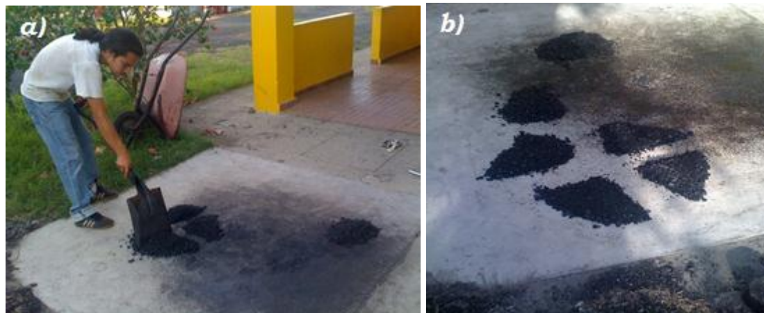
FIGURA 5.4 – Cuarteo de la mezcla asfáltica: Procedimiento de Cuarteo, Fracciones resultantes al final del cuarteo.
