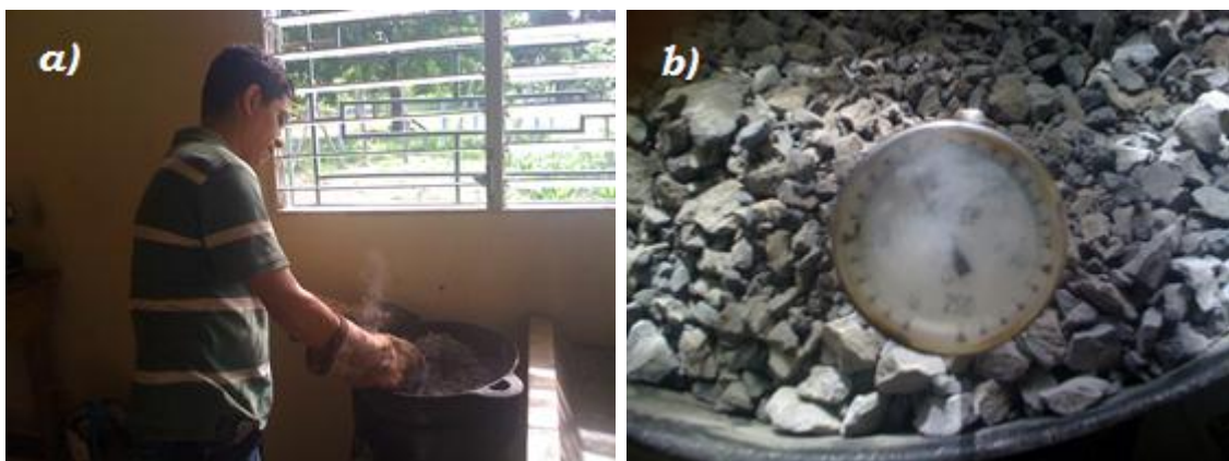
FIGURA 5.2 – Calentamiento previo de agregados: Mezclado de agregados durante calentamiento, Verificación de temperatura.
