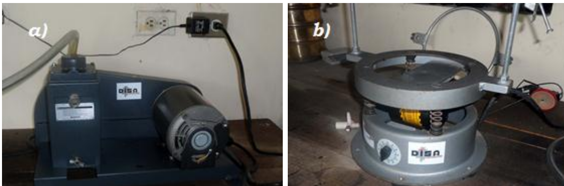
FIGURA 5.13 – Equipo teórica máxima: Equipo para generar vacío. Agitador Mecánico.
