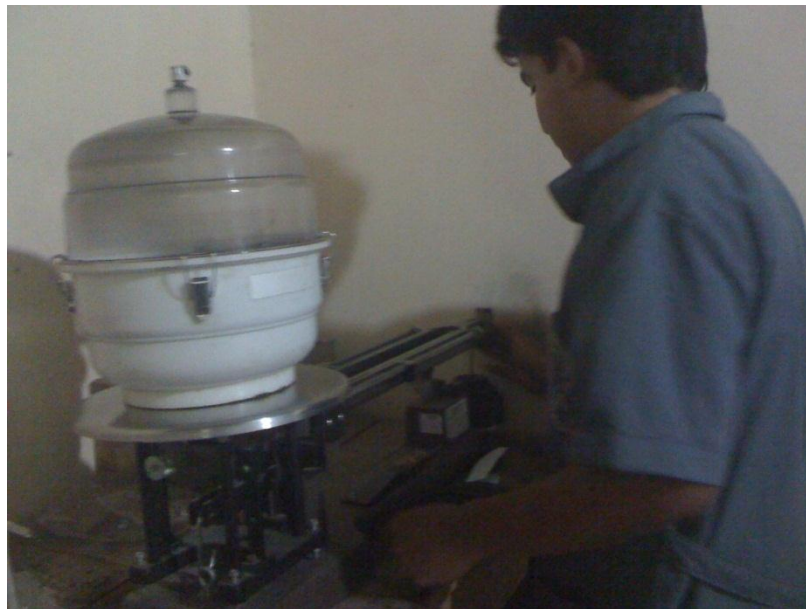
FIGURA 5.16 – Pesado en aire de Picnómetro + Agua + Mezcla.
