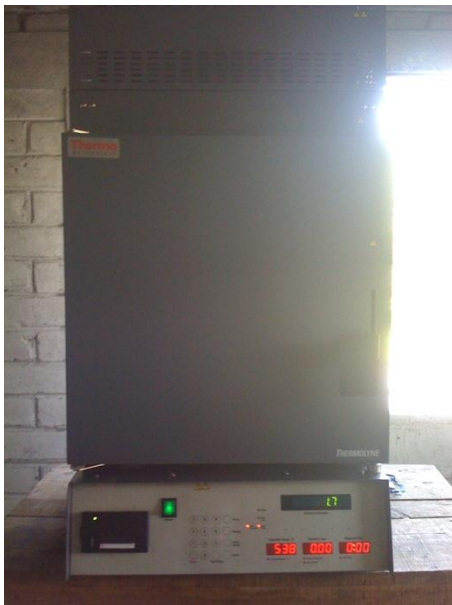
FIGURA 5.25 – Horno para el ensayo de extracción de asfalto por el método de ignición ASTM D6307-05.
