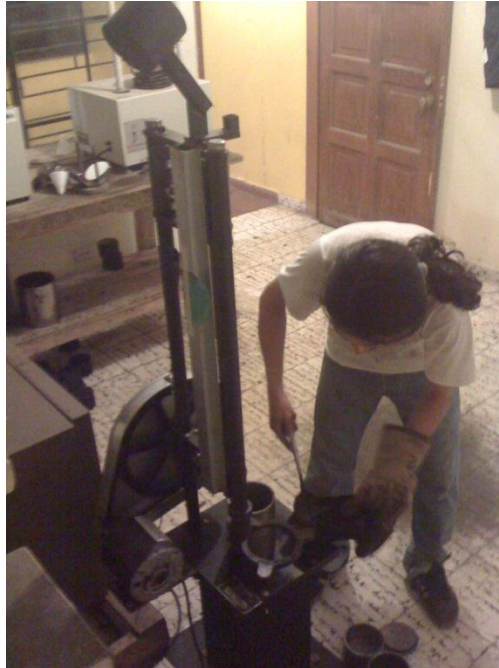
FIGURA 5.6 – Colocación de la mezcla en el molde de compactación. Fuente: Laboratorio Planta Asfáltica, Plantel Los Zacatillos Constructora DISA, Zacatecoluca, La Paz
