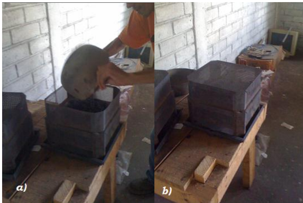
FIGURA 5.26 –Ensayo de extracción de asfalto por el método de ignición ASTM D6307-05: a) Colocación de muestra de mezcla asfáltica en contenedores. b) Contenedores con la mezcla a ensaya ante de introducirse al horno.
