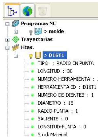
Figura 2.144 Detalles de la herramienta en el Explorador.
