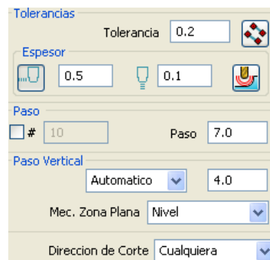
Figura 2.145 Edición de Tolerancias, Espesor, Paso y Paso Vertical.
