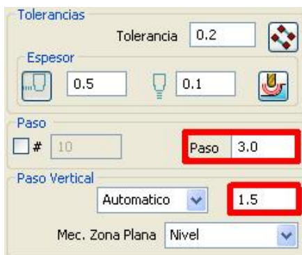
Figura 2.157 Modificar el Paso y Paso Vertical.
