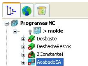
Figura 2.200 Trayectoria de acabado agregado a Programas NC molde.
