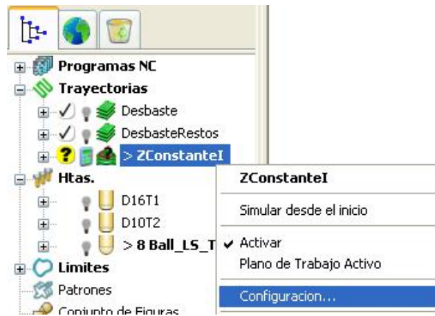
Figura 2.184 Seleccionar Configuración de la trayectoria ZConstanteI.
