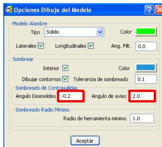
Figura 2.124 Modificar Ángulo Desmoldeo y Ángulo de aviso.
