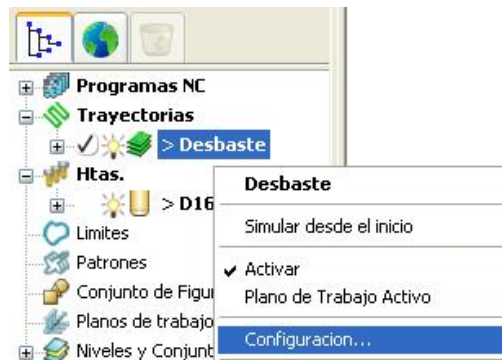
Figura 2.154 Seleccionar Configuración de la trayectoria Desbaste.
