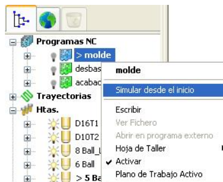
Figura 2.230 Simulación del Programa NC molde.
