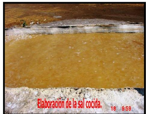
se mide el agua en grados centígrados. Si el agua tiene una temperatura de 18 °C. está lista para subirla con una bomba a las pailas del horno en las que el agua es cocida hasta que queda la sal lista para ser comercializada o almacenada. (Ver Anexo 3).
