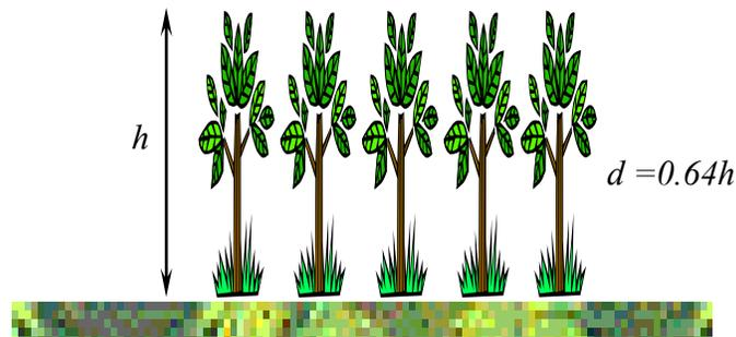
**Fig. 2.4.** Esquema que muestra la forma de estimar el factor de corrección “d”
