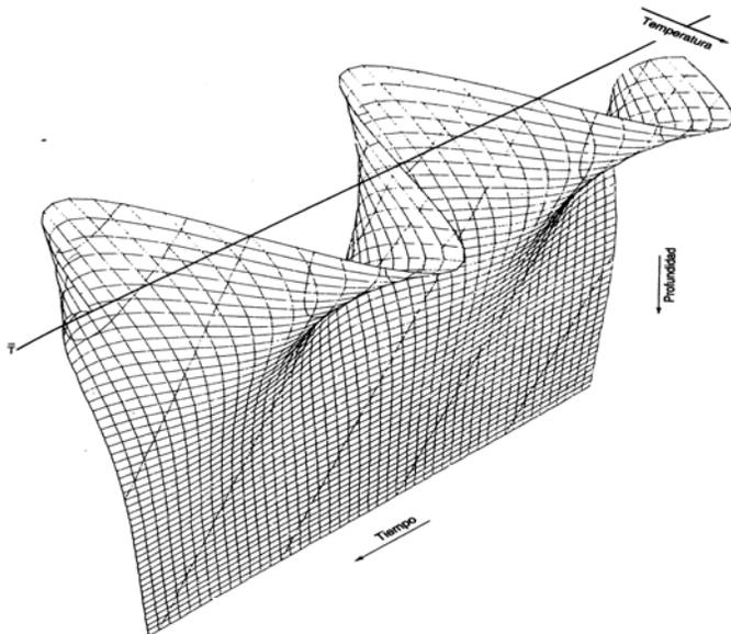
**Fig. 2.11. a)** Gráfico tridimensional de la temperatura del suelo como función del tiempo y de la profundidad, mostrando la atenuación de la onda de temperatura con la profundidad y el retardamiento de la máxima y mínima a tiempos posteriores con el aumento de la profundidad, como es expresado por la ecuación 2.16 (Principios de microclimatología. Inzunza, J. 2002)
