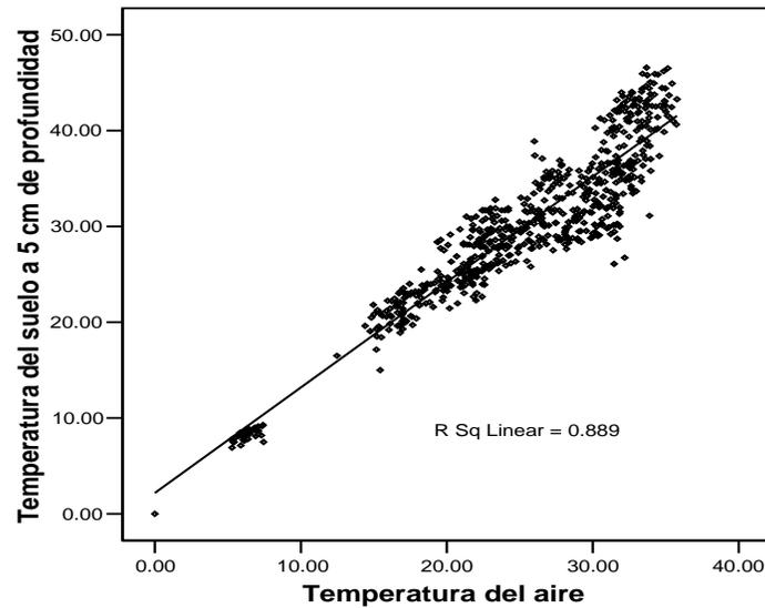
**Fig. 4.14.** Estudio de correlación lineal de la temperatura del suelo (°C) a 5.0 cm de profundidad con la temperatura del aire para el periodo III (del 09 de noviembre de 2002 hasta el 30 de abril de 2003). Se muestra la recta del ajuste con su respectivo coeficiente de correlación.
