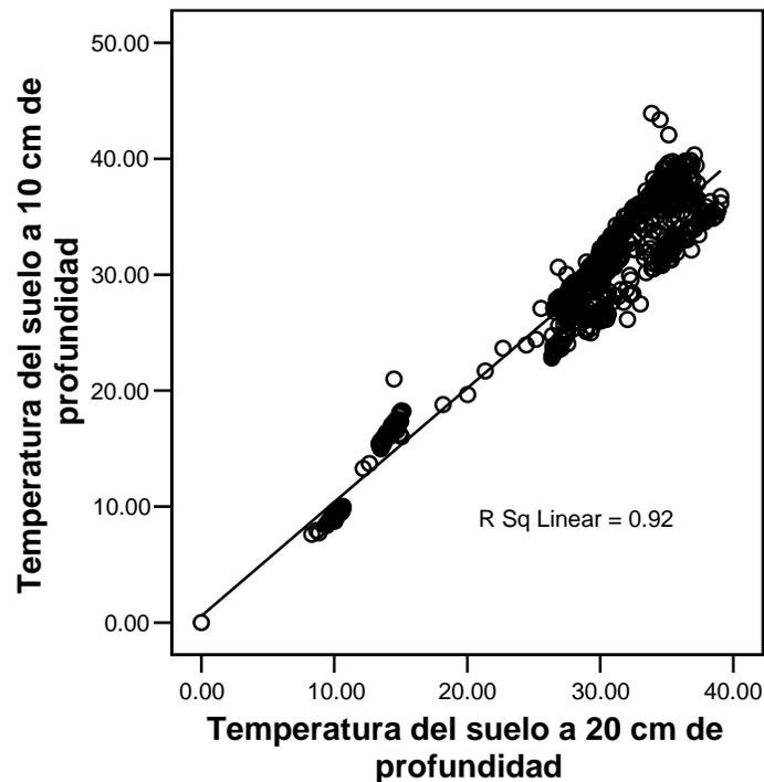
**Fig. 4.18.** Estudio de correlación lineal de la temperatura del suelo ( $^{\circ}\text{C}$ ) o a 10.0 cm de profundidad con la temperatura del suelo a 20.0 cm de profundidad para el período III (del 09 de noviembre de 2002 hasta el 30 de abril de 2003). Se muestra la recta del ajuste con su respectivo coeficiente de
