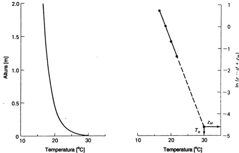
**Fig. 2.5.** Perfil típico de temperatura durante el día trazado como una función de la altura (izquierda) y del logaritmo de la altura (derecha). El gráfico logarítmico muestra la extrapolación del perfil medido a  $z = d = z_h$  para determinar la temperatura de la superficie. (Principios de microclimatología. Inzunza, J. 2002)
