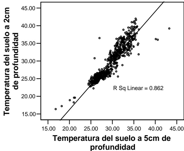
*Fig. 4.12. Estudio de correlación lineal de la temperatura del suelo ( $^{\circ}\text{C}$ ) a 2.0 cm de profundidad con la temperatura del suelo a 5.0 cm de profundidad para el período II (del 18 de mayo hasta el 08 de noviembre de 2002). Se muestra la recta del ajuste con su respectivo coeficiente de correlación.*
