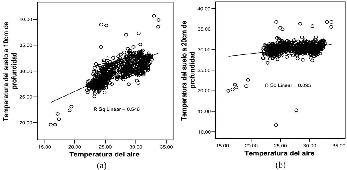
*Fig. A2.1. Estudio de correlación lineal de la temperatura del aire con (a) la temperatura del suelo a 10.0 cm y, (b) la temperatura del suelo a 20.0 cm para el período II (de 18 de mayo hasta el 08 de noviembre de 2002). Se muestra la recta del ajuste con su respectivo coeficiente de correlación.*
