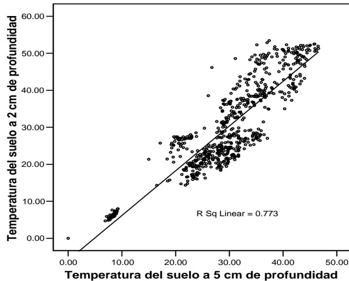
**Fig. 4.16.** Estudio de correlación lineal de la temperatura del suelo ( $^{\circ}\text{C}$ ) a 2.0 cm de profundidad con la temperatura del suelo a 5.0 cm de profundidad para el periodo III (del 09 de noviembre de 2002 hasta el 30 de abril de 2003). Se muestra la recta del ajuste con su respectivo coeficiente de correlación.
