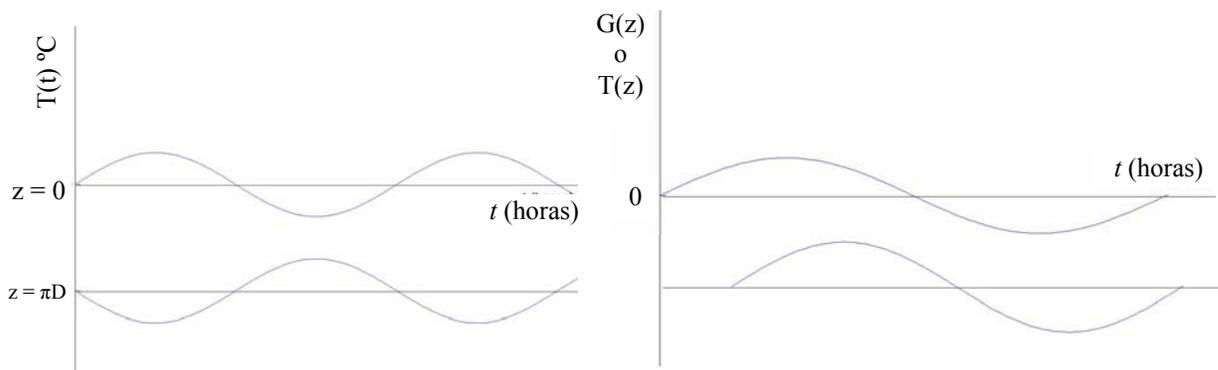
**Fig. 2.9.** Comportamiento periódico de la temperatura para las profundidades  $z = 0$  y  $z = \pi D$
