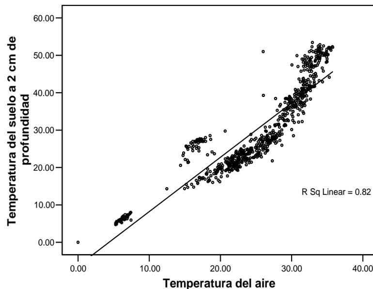
**Fig. 4.13.** Estudio de correlación lineal de la temperatura del suelo (°C) a 2.0 cm de profundidad con la temperatura del aire para el período III (del 09 de noviembre de 2002 hasta el 30 de abril de 2003). Se muestra la recta del ajuste con su respectivo coeficiente de correlación.
