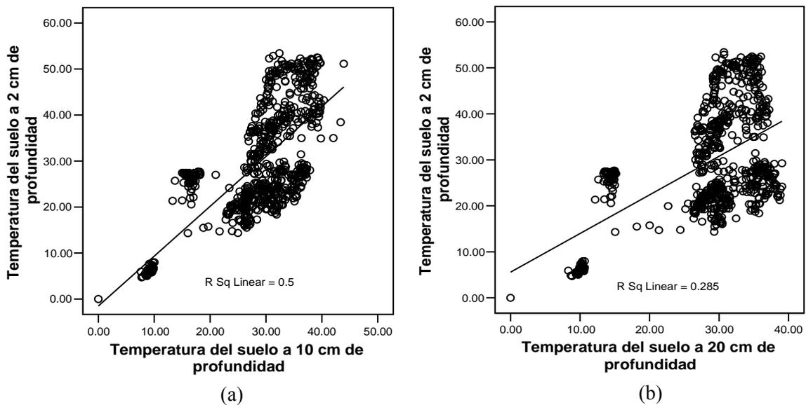
*Fig. A3.2. Estudio de correlación lineal de la temperatura del suelo a 2.0 cm con (a) la temperatura del suelo a 10.0 cm y, (b) la temperatura del suelo a 20.0 cm para el período III (del 09 de noviembre de 2002 hasta el 30 de abril de 2003). Se muestra la recta del ajuste con su respectivo coeficiente de correlación.*
