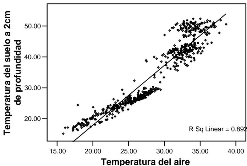
*Fig. 4.7. Estudio de correlación lineal de la temperatura del suelo (°C) a 2.0 cm de profundidad con la temperatura del aire para el período I (del 01 de enero hasta el 17 de mayo de 2002). Se muestra la recta del ajuste con su respectivo coeficiente de correlación.*
