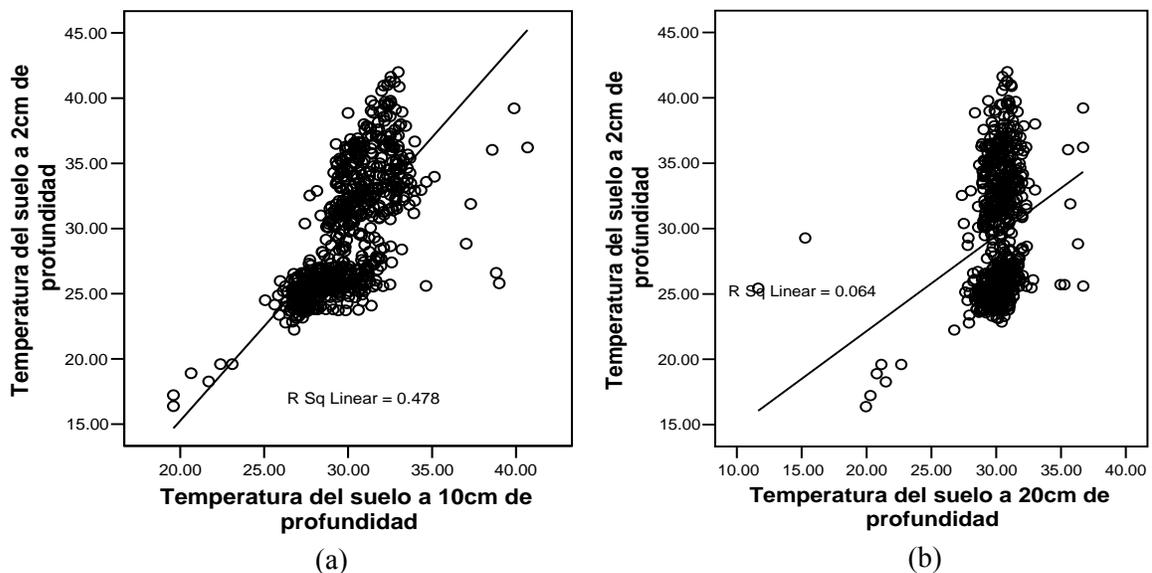
*Fig. A2.2. Estudio de correlación lineal de la temperatura del suelo a 2.0 cm con (a) la temperatura del suelo a 10.0 cm y, (b) la temperatura del suelo a 20.0 cm para el período II (del 18 de mayo hasta el 08 de noviembre de 2002). Se muestra la recta del ajuste con su respectivo coeficiente de correlación.*
