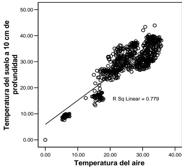
**Fig. 4.15.** Estudio de correlación lineal de la temperatura del suelo (°C) a 10.0 cm de profundidad con la temperatura del aire para el periodo III (del 09 de noviembre de 2002 hasta el 30 de abril de 2003). Se muestra la recta del ajuste con su respectivo coeficiente de correlación.
