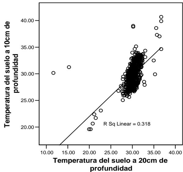
**Fig. A2.4.** Estudio de correlación lineal de la temperatura del suelo a 10.0 cm con la temperatura del suelo a 20.0 cm para el período II (del 18 de mayo hasta el 08 de noviembre de 2002). Se muestra la recta del ajuste con su respectivo coeficiente de correlación.
