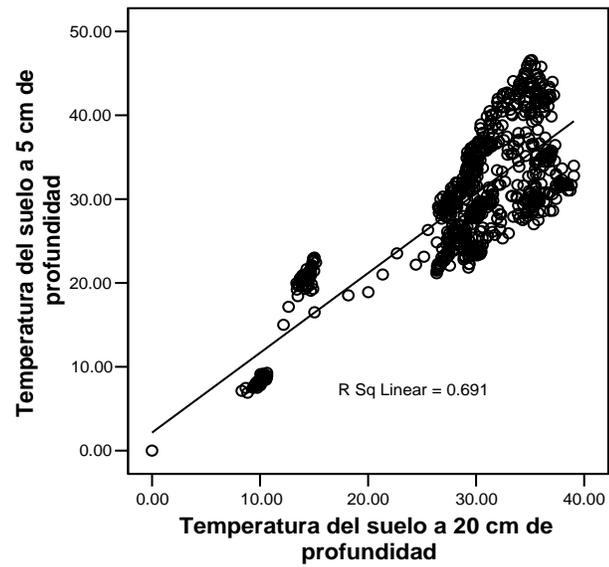
**Fig. A3.3.** Estudio de correlación lineal de la temperatura del suelo a 5.0 cm con la temperatura del suelo a 20.0 cm para el período III (del 09 de noviembre de 2002 hasta el 30 de abril de 2003). Se muestra la recta del ajuste con su respectivo coeficiente de correlación.
