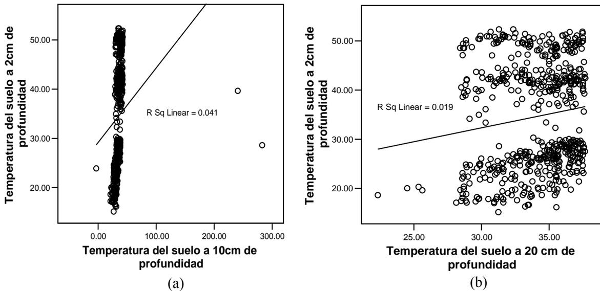
*Fig. A1.2. Estudio de correlación lineal de la temperatura del suelo a 2.0 cm con (a) la temperatura del suelo a 10.0 cm y, (b) la temperatura del suelo a 20.0 cm para el período I (del 01 de enero hasta el 17 de mayo de 2002). Se muestra la recta del ajuste con su respectivo coeficiente de correlación.*
