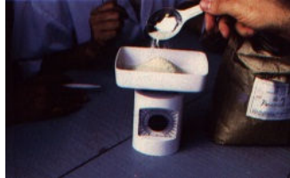
Figura III. 37 Balanza de Aguja para medir peso de levadura
