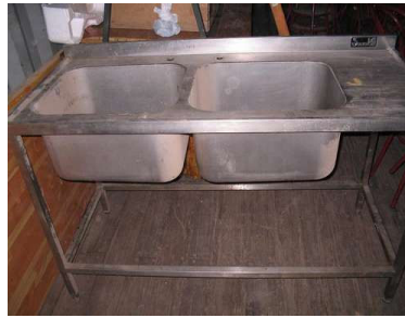
Fig. III.19. Lavadero metálico para lavar frutos de Noni (repetida)
