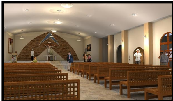
Detalle de cielo falso de Tabla roca con luminarias empotradas de ojo de buey
