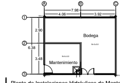
Planta de Instalaciones Hidráulicas de Mantenimiento Esc: 1:100
