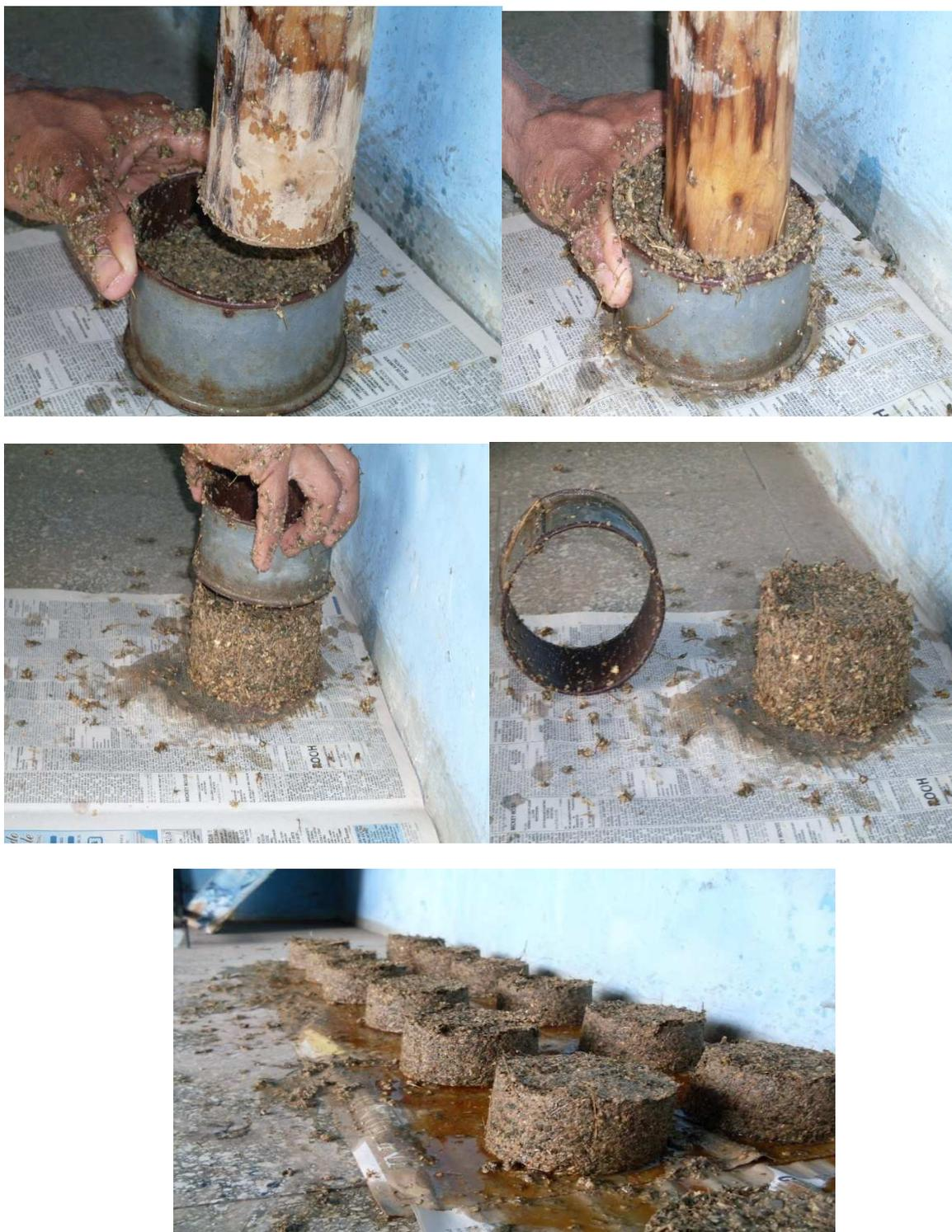
Figura A5: Proceso de compactado de los bloques.
