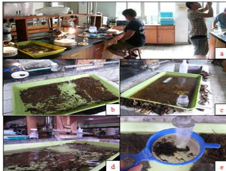
Figura 5. a) área de trabajo de laboratorio, b) limpieza de material por medio de inundación, c) depuración de material orgánico como hojas, trozos de troncos y raíces, d) limpieza a profundidad, e) selección de sustrato con macroinvertebrados; auxiliándose de coladores de uso doméstico.
