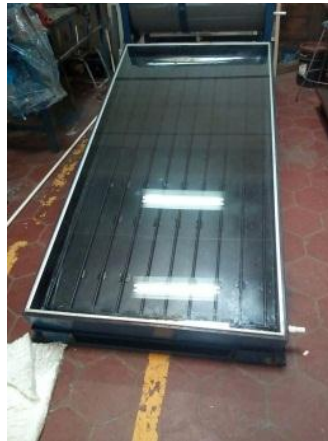
Figura 55: Colector solar plano construido. (2018). [Fotografía]. Fuente: Los autores.
