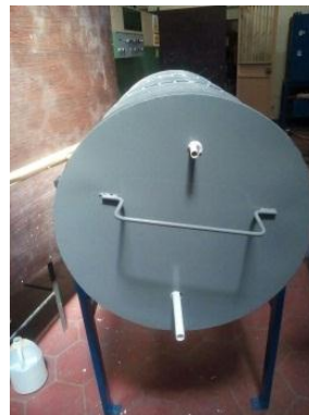
Figura 56: Tanque acumulador construido. (2018). [Fotografía]. Fuente: Los autores.
