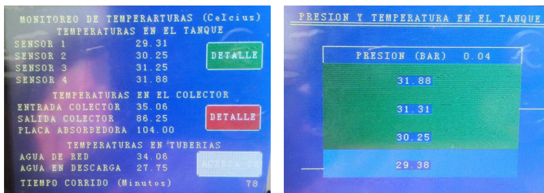
Figura 62: Elementos de la pantalla del sistema de monitoreo de temperaturas del sistema solar térmico. (2018). [Fotografía]. Fuente: Los autores.
