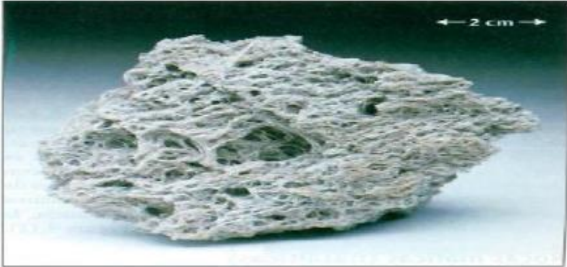
Figura 5 Muestra de mano de pumita, una roca vítrea que contiene numerosas vesículas 3
