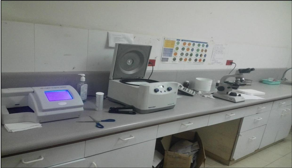
*Imagen 3.55: Los equipos de laboratorio están en buen estado y funcionando, pero no se encuentran anclados.*
