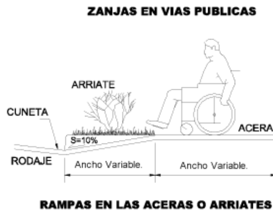
Figura 26 Detalle de rampa en acera
