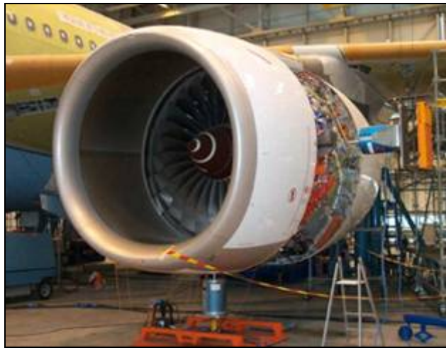
Figura 39. Ejemplo de Distribución fija. Todo el equipo de trabajo y el recurso humano llega a la pieza principal
