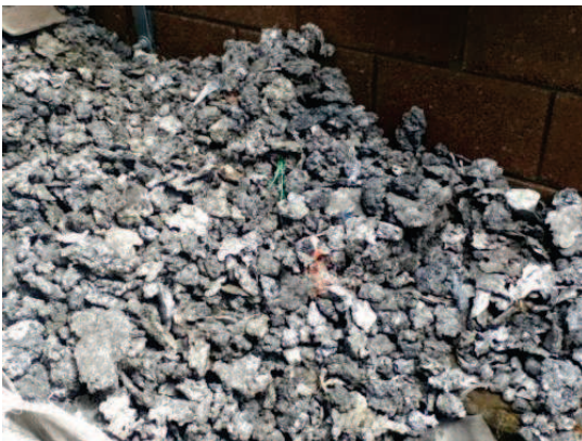
Figura 5-1 Escoria salina suelta de aluminio secundario
