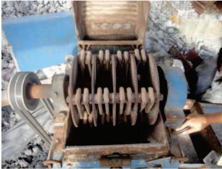
Figura 5-4 Molino de martillos utilizado para la trituración de la muestra de escoria salina de aluminio propiedad de empresa A.
