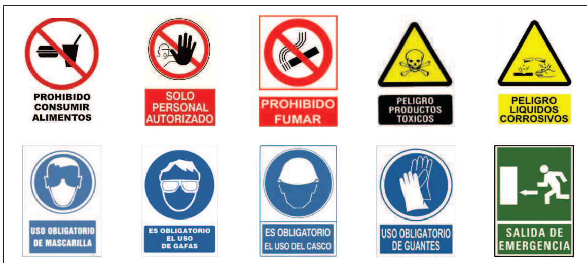
Figura 6-3 Ejemplos de señalización recomendada para bodega de escorias salinas de aluminio secundario
