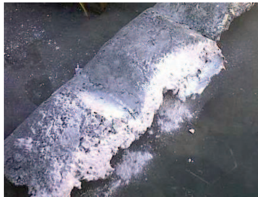
Figura 5-2 Escoria salina compacta de aluminio secundario
