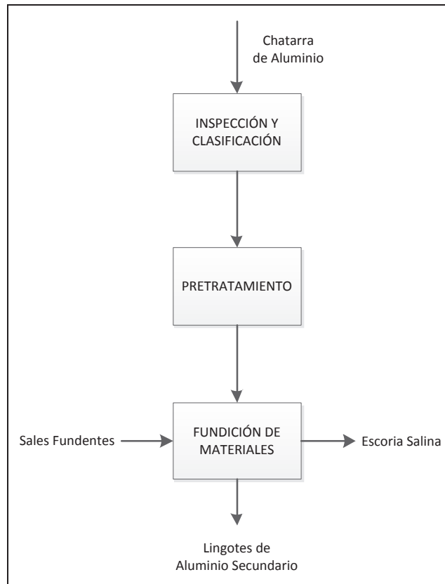
Figura 2-1 Procedimiento general de producción de aluminio secundario (Gil, 2006)
