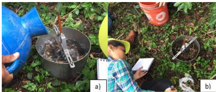
Figura 1 a) llenado de cilindro infiltometro b) toma de datos
