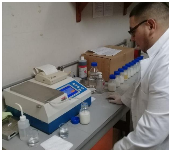
Figura 5. Equipo utilizado para el análisis físico químico Y medición de parámetros nutricionales de las muestras de leche.
