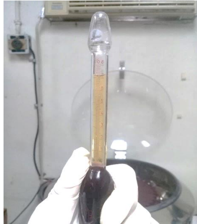
Figura 6. Medidas de grasa de las muestras método de Gerber se lee 7.3% de grasa.
