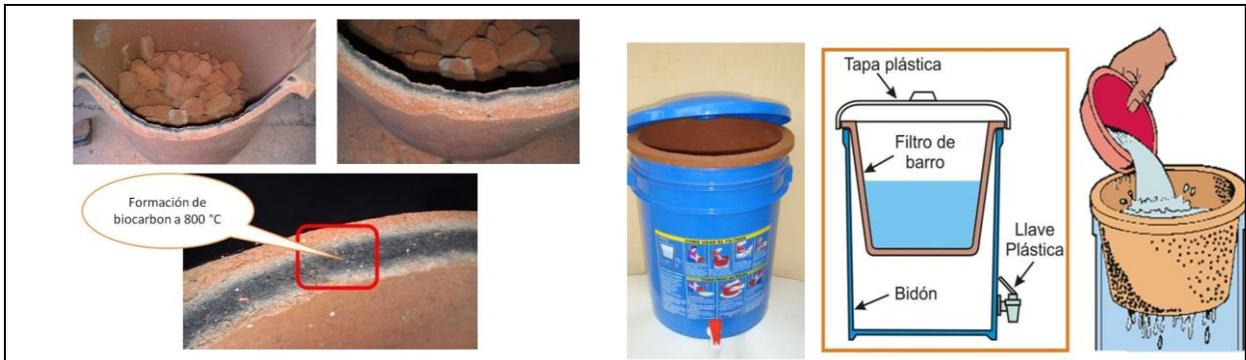
Figura 2. Capa de biocarbon y plata coloidal, características de los filtros y su funcionamiento. (ANDA 2016)
