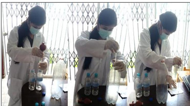
Figura 7. Procedimiento para preparar agua con concentraciones conocidas de arsénico y plomo.
