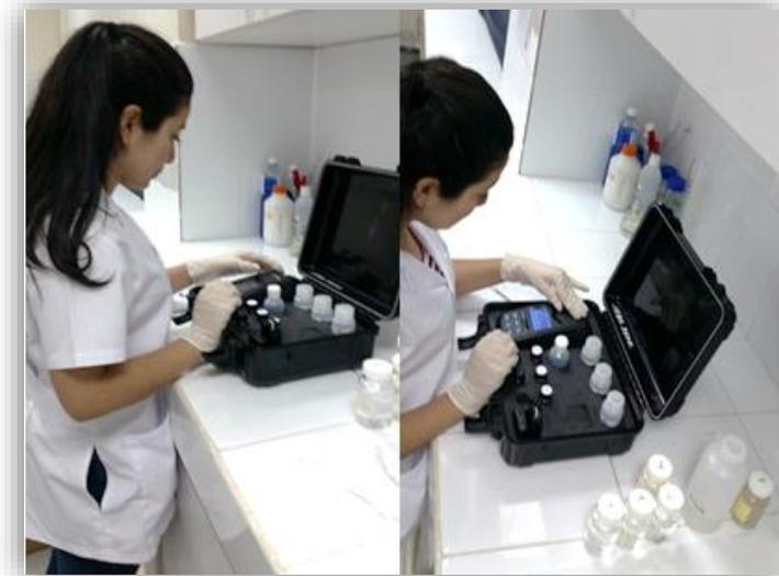
Figura 12. Medición de turbidez.
